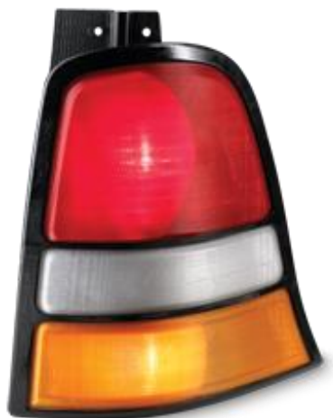
Slika 2.3. Tvorevina izrađena od ABS-i materijala [4]
