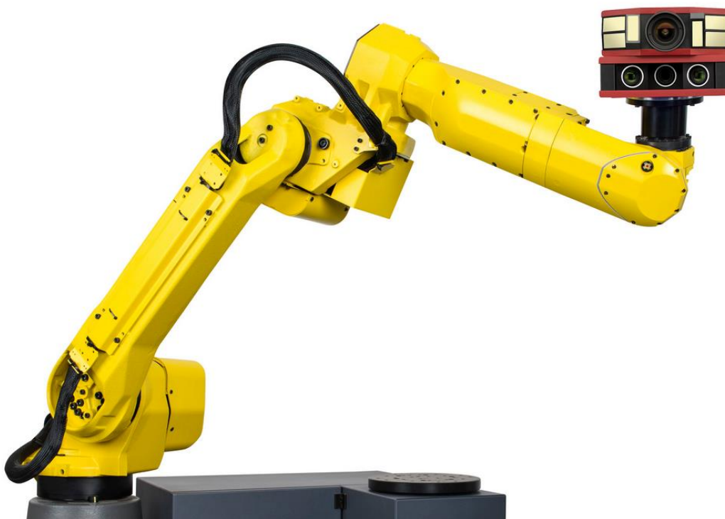
Slika 14. Robotizirani fotogrametrijski sustav [17]
