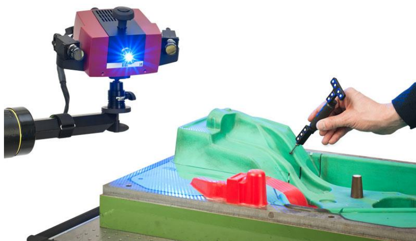
Slika 47. Projekcija uzorka + fotogrametrija + kontaktno mjerenje [56]
