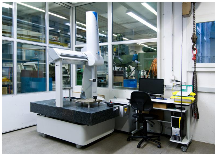
Slika 3. Višesenzorni trokoordinatni mjerni uređaj [5]
