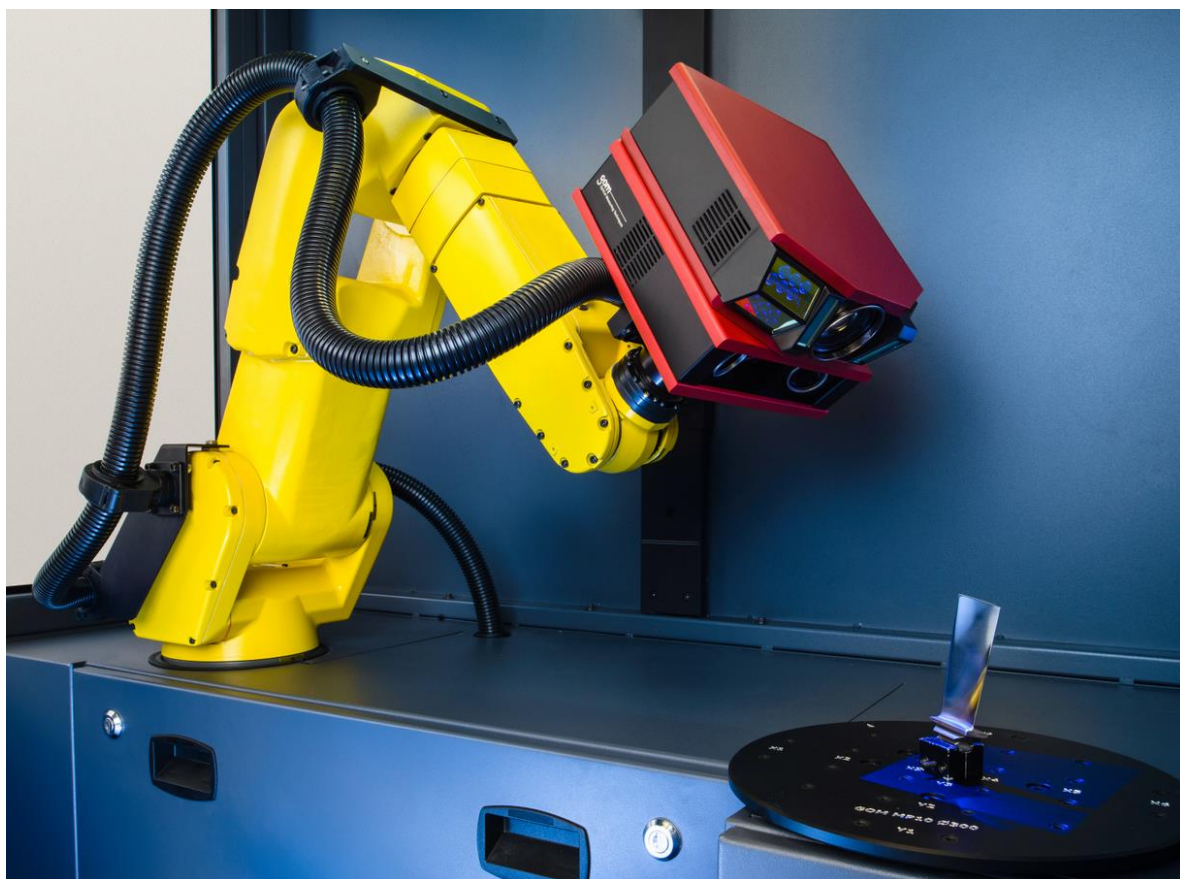
Slika 19. Skeniranje plavim svjetlom [26]
