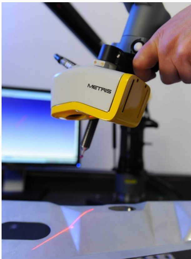
Slika 9. 3D mjerna ruka sa laserski skenerom [12]
