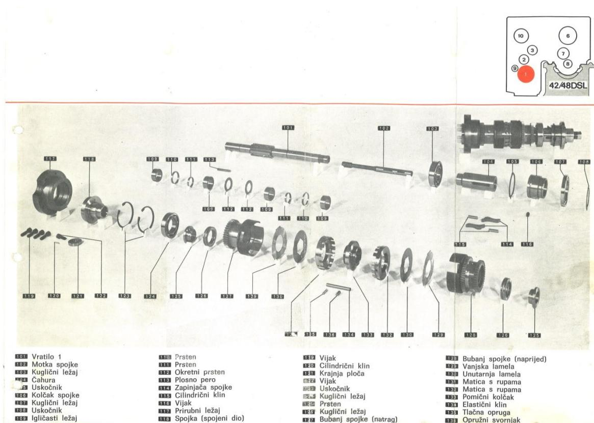
Slika 21. Pogonska (*kuplning*) osovina
