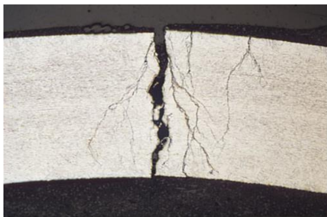
Slika 8. Poprečni presjek pukotine nastale napetosnom korozijom na čeliku AISI 304 izloženom običnoj vodi temperature 60\text{ }^{\circ}\text{C} [12]
