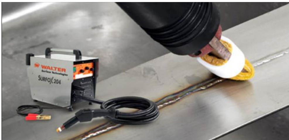
Slika 11. Elektrokemijsko čišćenje zavara uređajem SURFOX 204 [19]
