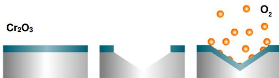
Slika 1. Mehanizam obnove pasivnog filma \text{Cr}_2\text{O}_3 [4]
