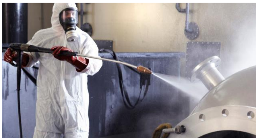
Slika 14. Nanošenje otopine prskanjem [23]
