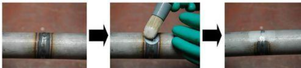
Slika 13. Čišćenje zavara pastom [22]
