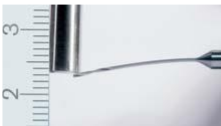
Slika 43 MIKRON CrazyDrill Flex, fleksibilnost mikro svrdla [12]
