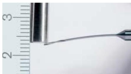
**Slika 43 MIKRON CrazyDrill Flex, fleksibilnost mikro svrdla [12]**
