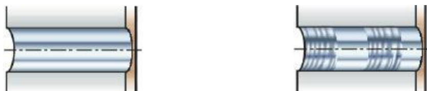
Slika 26 Provrt sa dobrim odvođenjem odvojene čestice (lijevo) i provrt sa lošim odvođenjem odvojene čestice (desno) [4]
