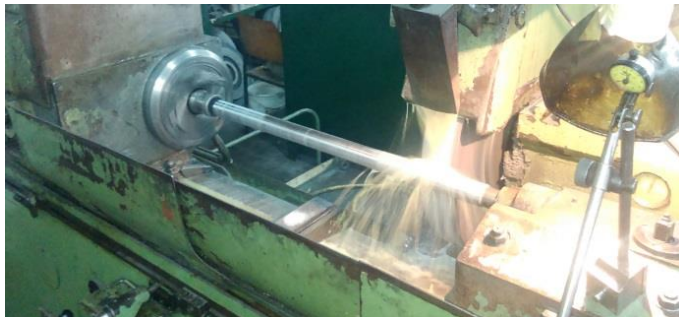
Slika 37: Vanjsko brušenje manje cijevi cilindra
