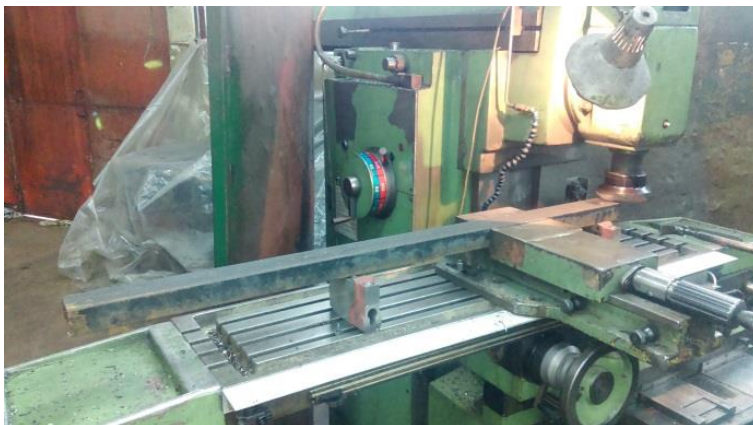
Slika 33: Obrada površine za montažu linearne vodilice
