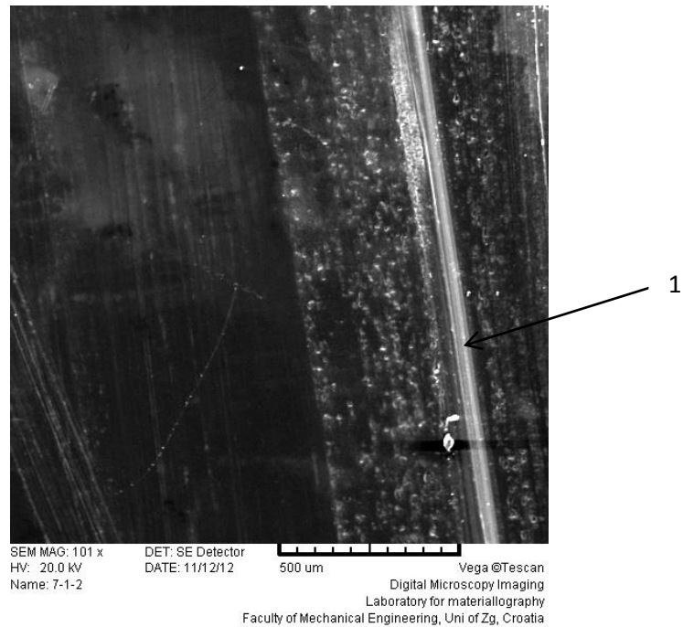
Slika 22. Hladno polimerizarni PMMA pri pH 7.098 pri pojačanju 100 puta
