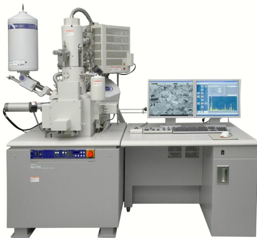
Slika 17. Skening elektronski mikroskop [14]
