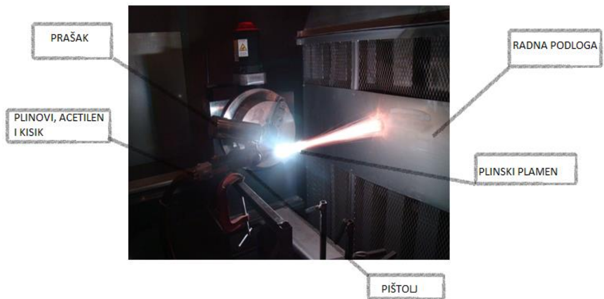
Slika 11 Plinsko naštrcavanje prahom [10]
