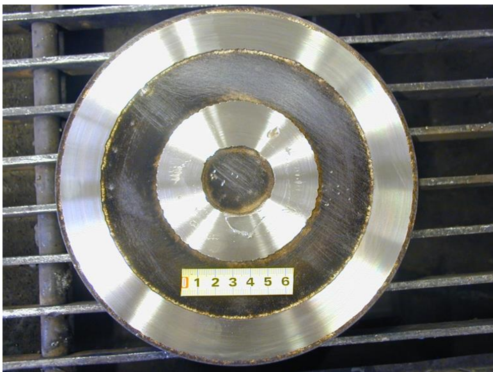
Slika 24 Obradak nakon dodatne obrade tokarenja [18]
