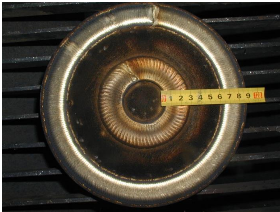
Slika 23 Obradak nakon nanosenoj sloja plazma navarivanjem [18]
