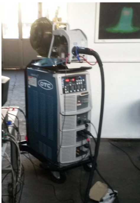
Slika 26. Izvor struje za zavarivanje OTC Daihen Welbee P500L
