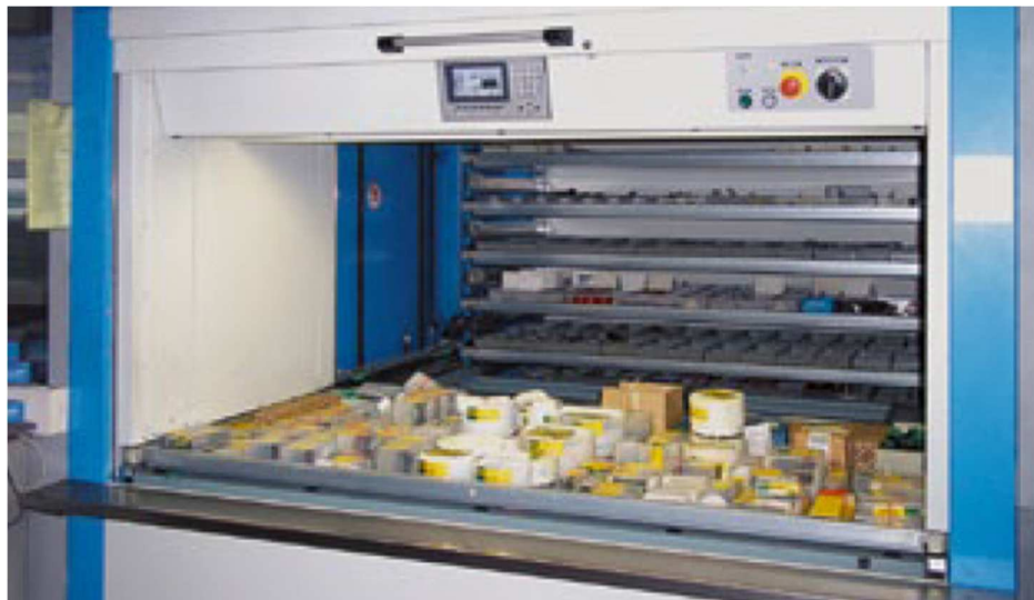
Slika 14. Prozor VLM-a s mjernim alatima Teh-cuta
