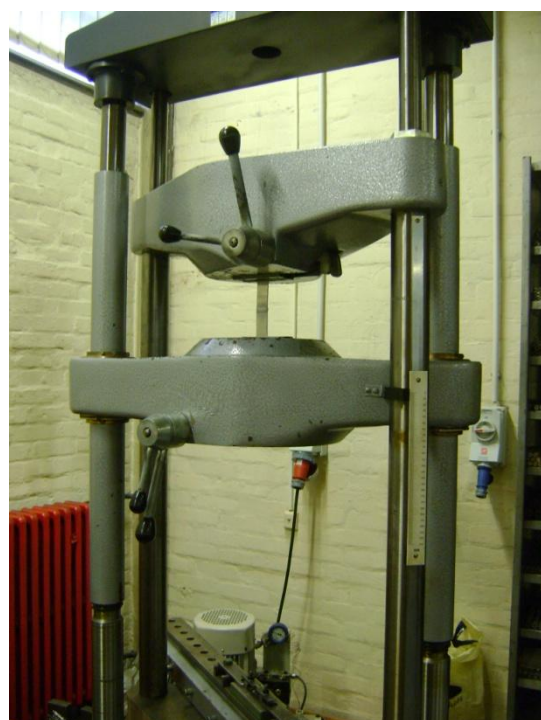
Slika 4.18. Epruveta u čeljustima kidalice
