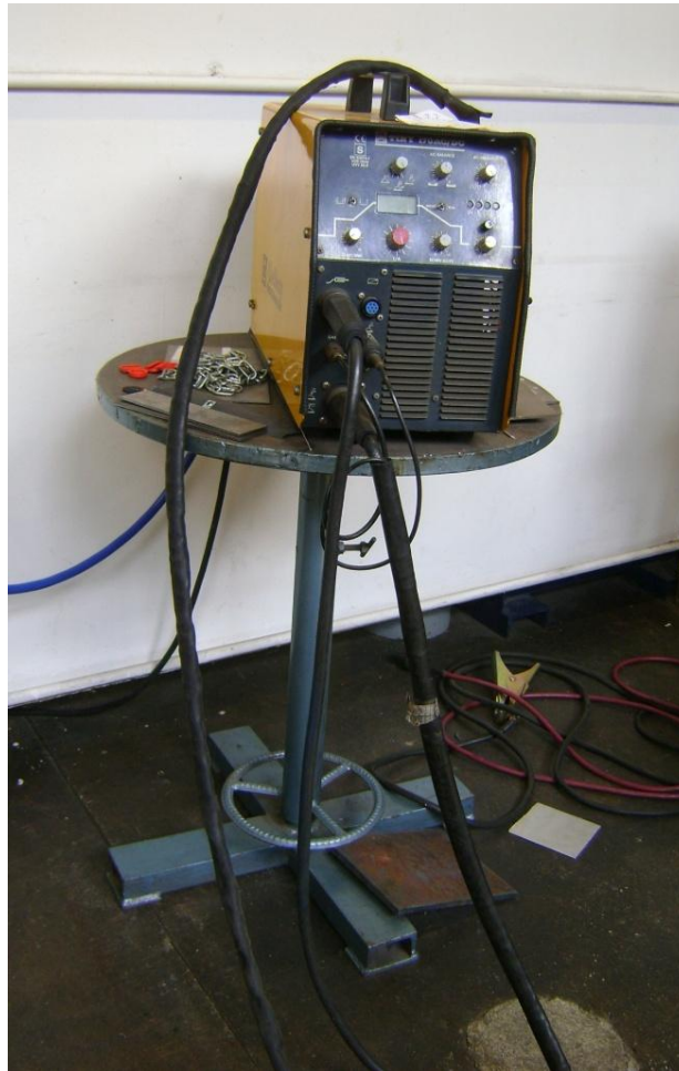
Slika 4.7. TINY 170AC/DC uređaj za TIG zavarivanje
