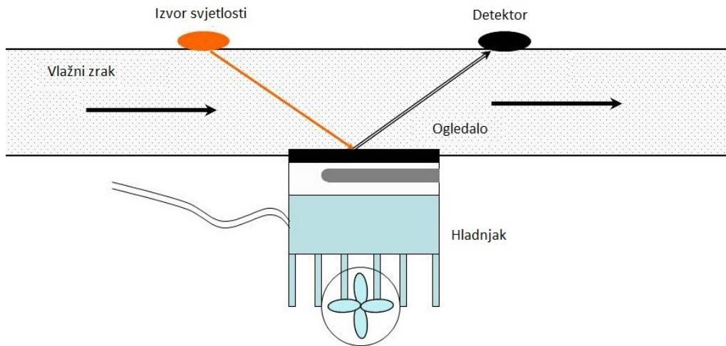
Slika 9 Shema kondenzacijskog higrometra
