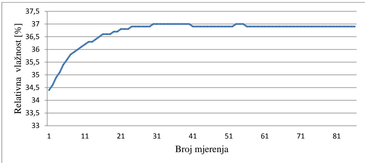
Prethodni podaci koje smo dobili odnose se na umjeravani higrometar. Njih moramo usporediti s etalonskim higrometrom. Ti su tablični i grafički podaci prikazani ispod.
