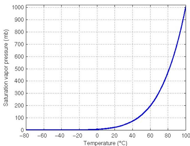
Slika 2 Tlak zasićenja vodene pare ovisi o temperaturi
