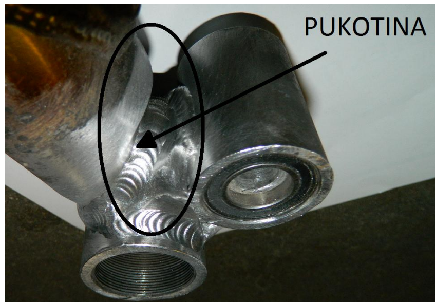
Slika 18. Pukotina na rubu zavora
