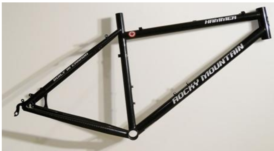
Slika 14. Izgled "tvrdorepog" (HT) okvira bicikla [21]
