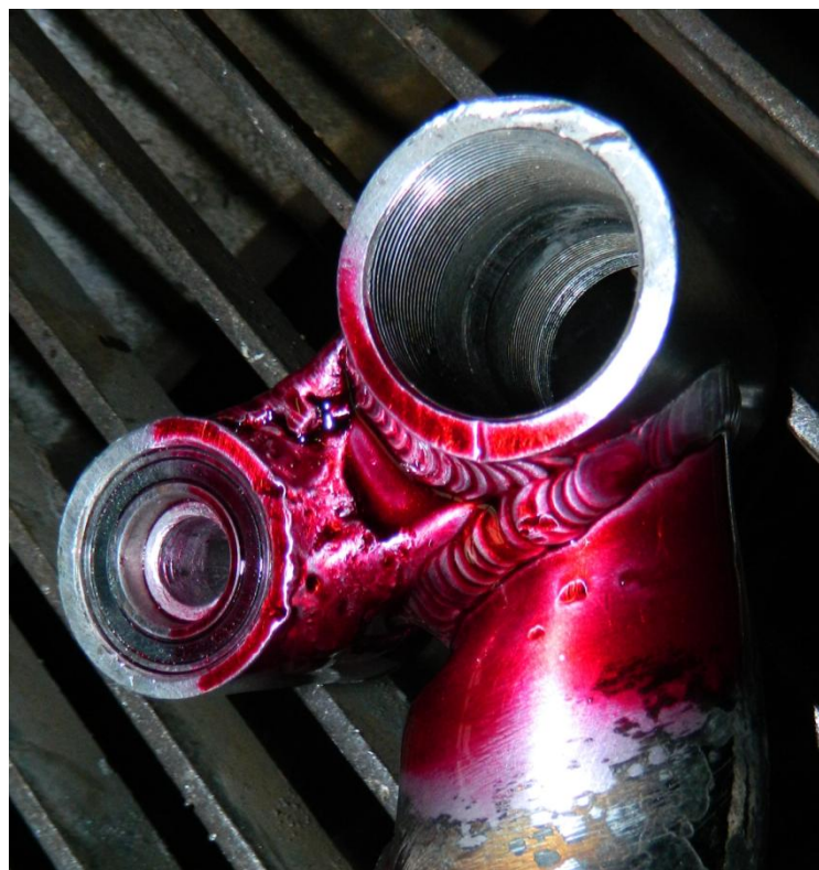
Slika 23. Penetrant nanesen na površinu zavara
