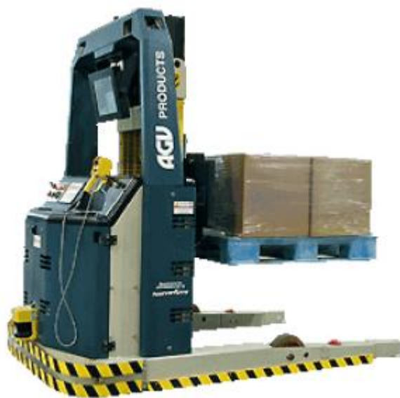
Slika 7. AGV viličar (paletizirana roba) [16]
