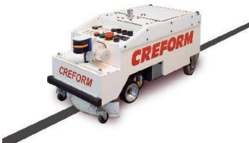
Slika 14. Optički način vođenja [18]
