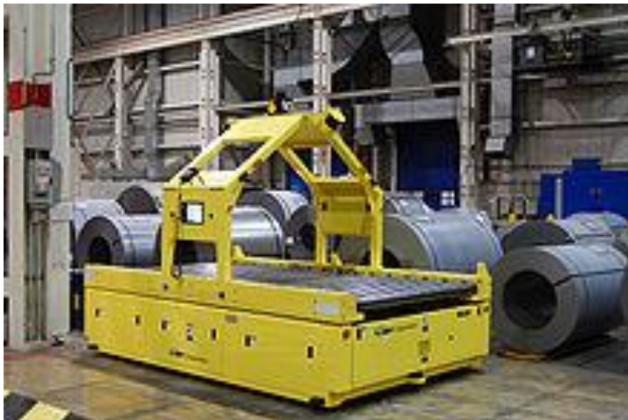
Slika 5. AGV vozilo jediničnih tereta (za čelične limove) [13]
