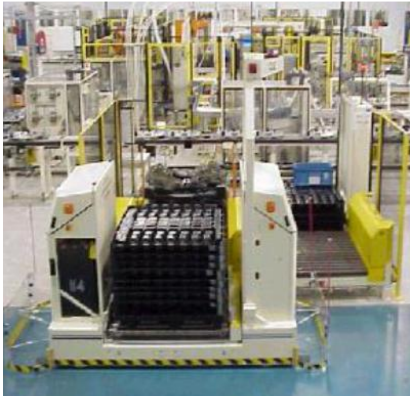
Slika 32. AGV u automobilskoj industriji [25]
