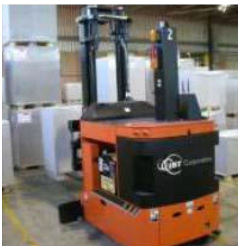
Slika 30. Paletno AGV vozilo u industriji papira [3]
