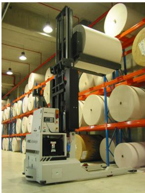
Slika 47. AGV vozilo u skladištu papirnatih rola [16]
