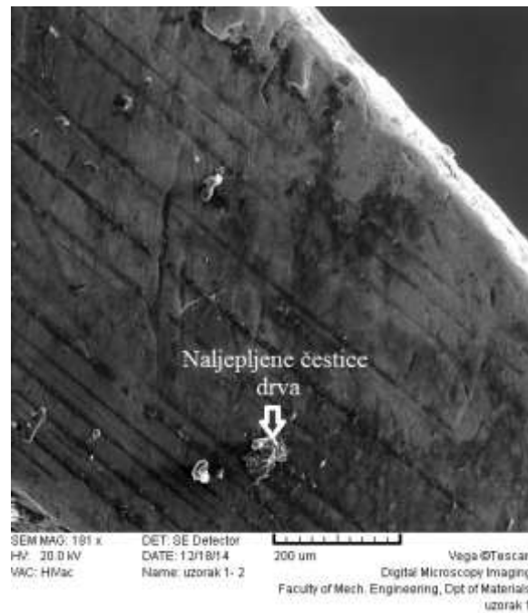
Slika 37. Naljepljivanje čestice drva
