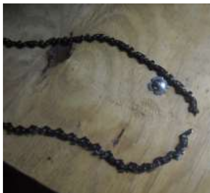
Slika 30. Lom lanca uslijed umora materijala članaka
