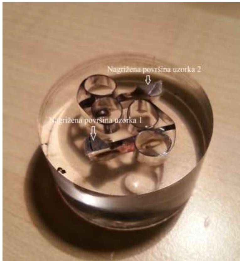
Slika 48. Nagrižene površine uzoraka 1 i 2
