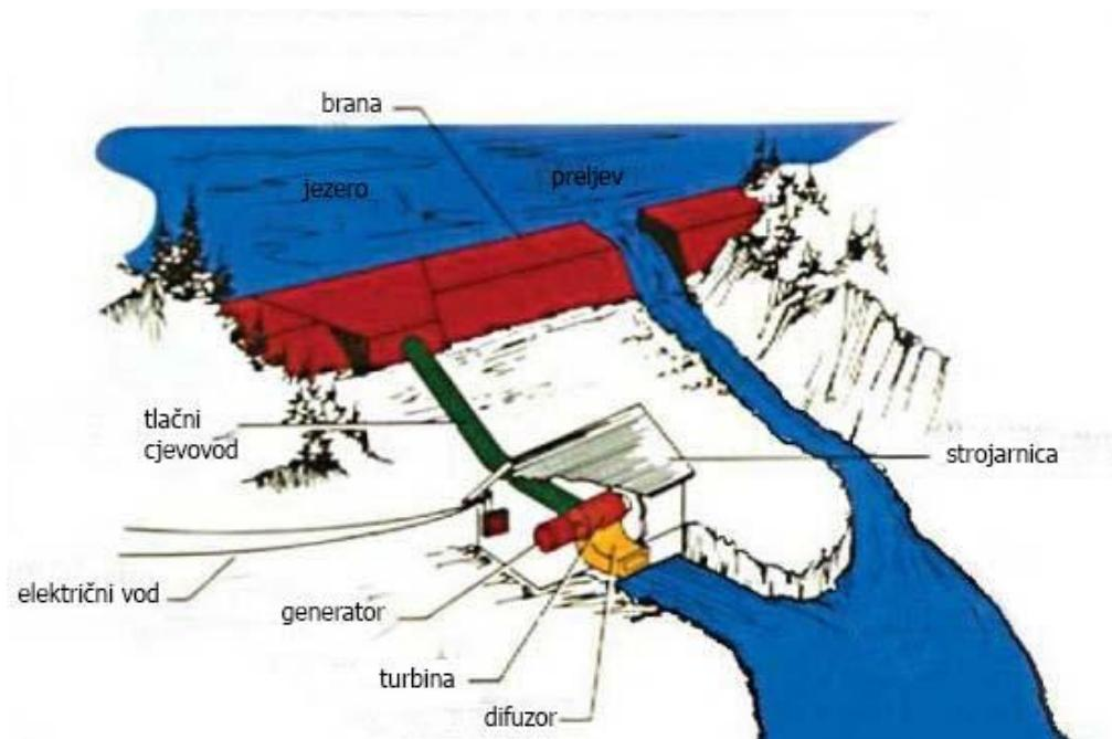
Slika 3. Komponente hidroelektrane
