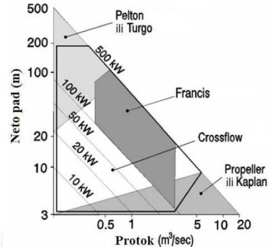
Slika 14. Dijagram za radna područja pojedinih turbina
