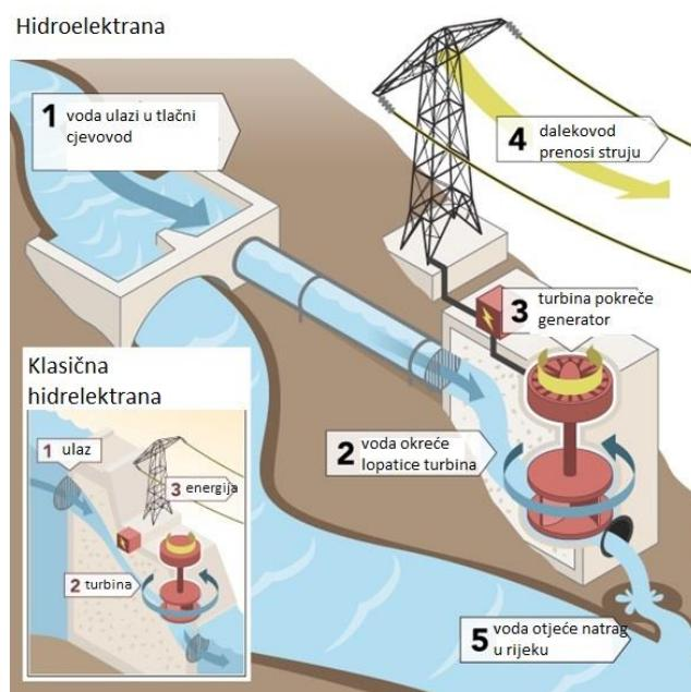
Slika 1. Protočna hidroelektrana
