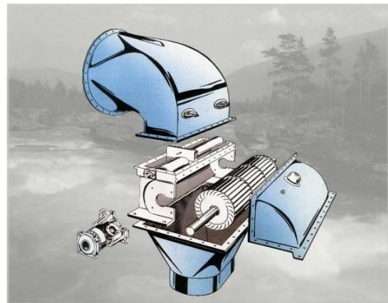
Slika 8. Crossflow turbina
