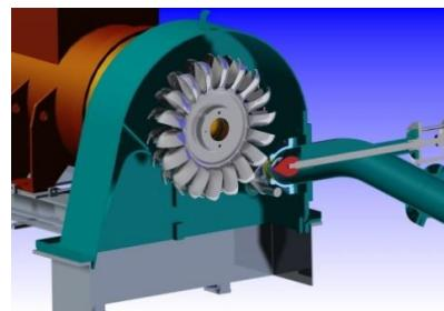
Slika 6. Pelton turbina
