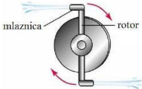
Slika 10. Reakcijska turbina
