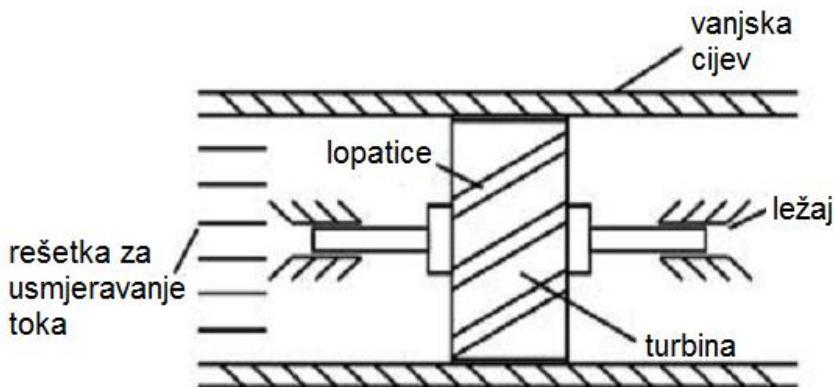
**Slika 5. Turbinsko mjerilo protoka**
