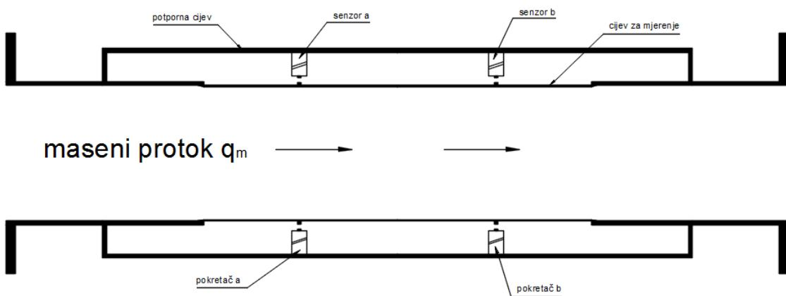
Slika 1. Konstrukcija Coriolis-ovog protokomjera
