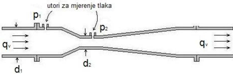
Slika 2. Venturijeva cijev
