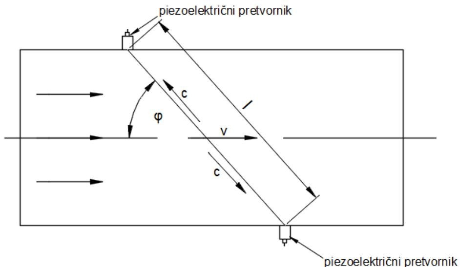
**Slika 7. Princip rada ultrazvučnog protokomjera vremena prolaza**
