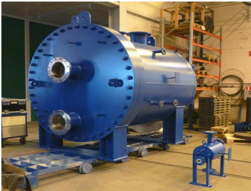
Slika 17. Izmjenjivač topline-isparivač [17]
