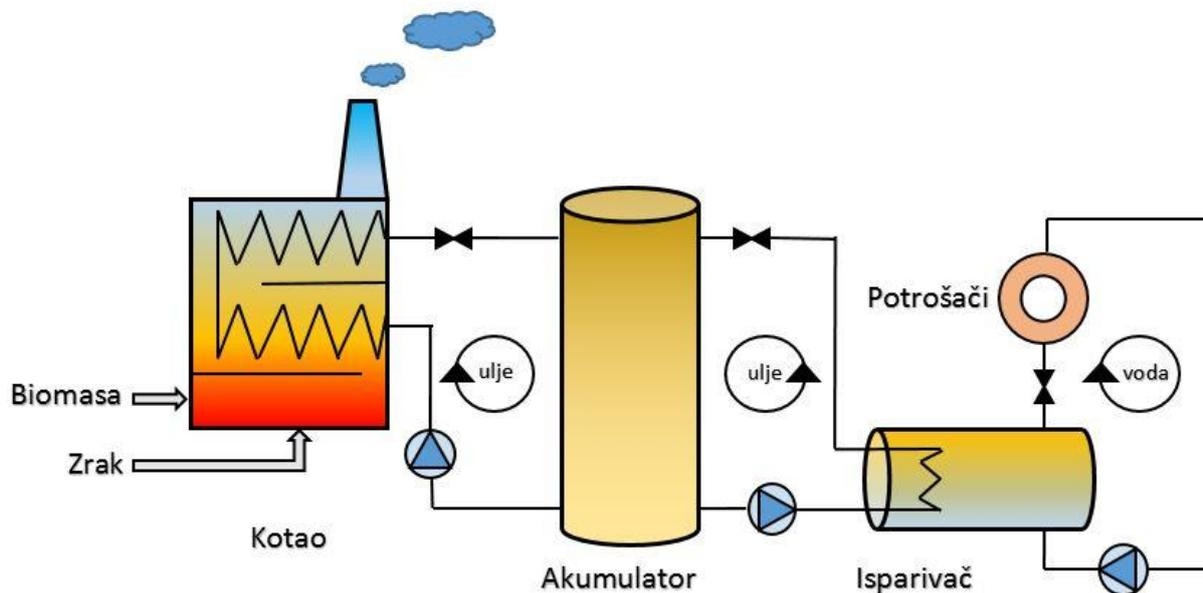
Slika 14. Shematski prikaz vrelouljnog sustava
