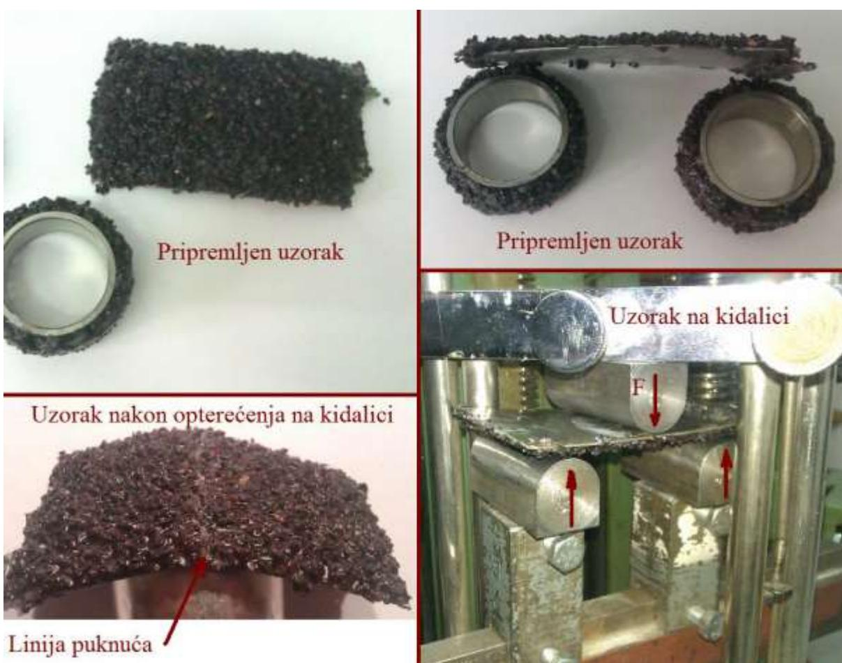
Slika 35. Ispitivanje uzorka na kidalici
