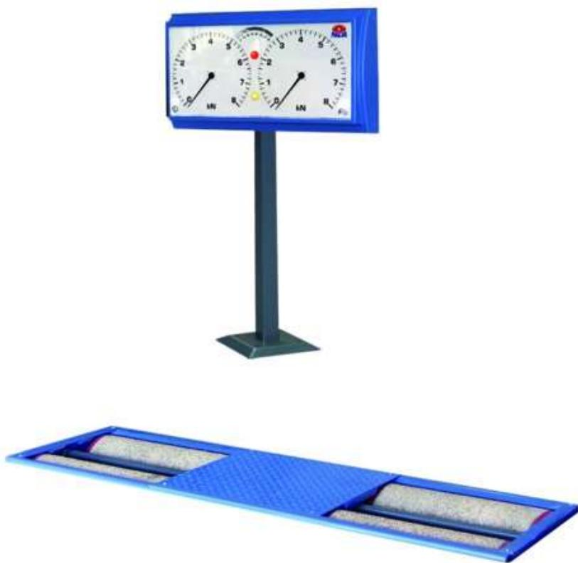
Slika 1. Valjci za ispitivanje sile kočenja [2]
