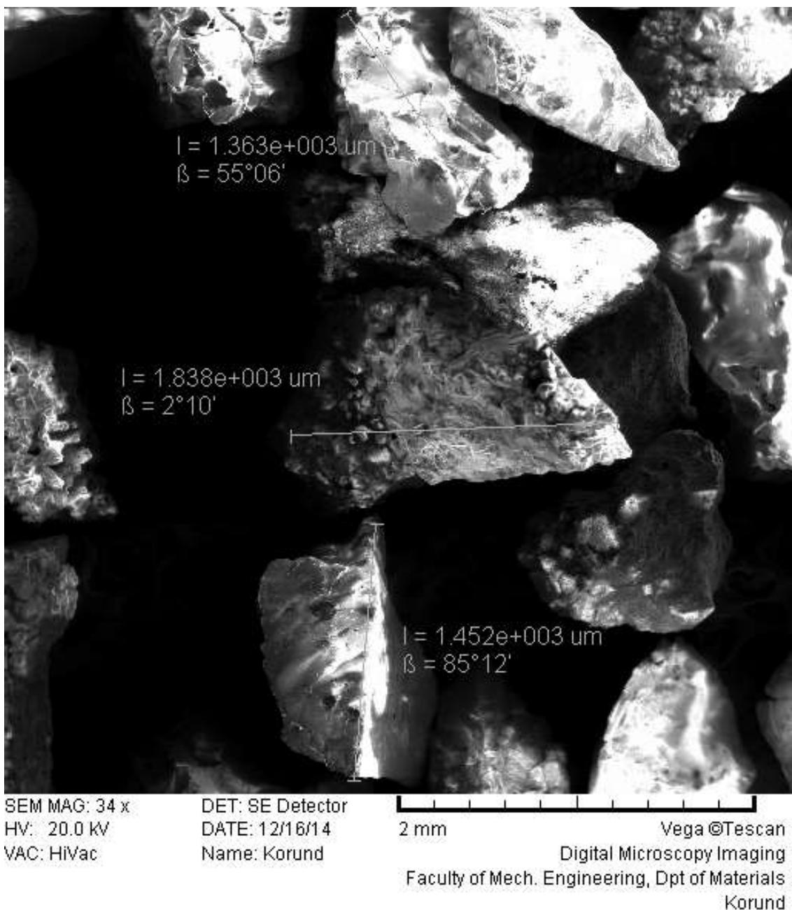
Slika 31. Snimka korunda na SEM-u pod povećanjem 34 x
