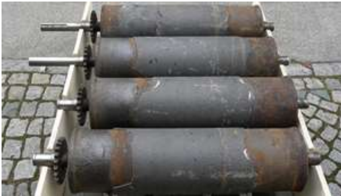
Slika 17. Valjci s kojih je otpala prevlaka [21]
