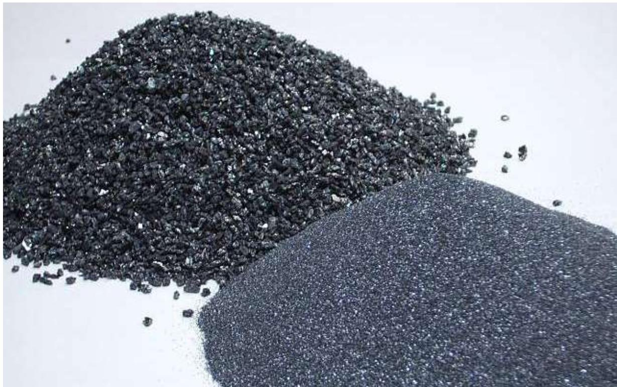
Slika 25. Granulat silicijevog karbida- SiC [25]
