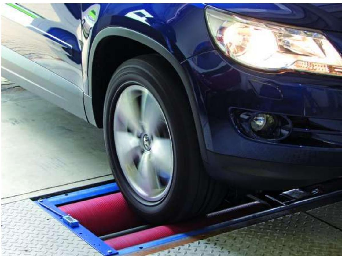
Slika 3. Vozilo na valjcima za ispitivanje sile kočenja [3]
