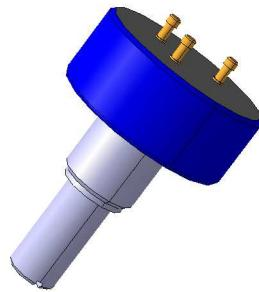
Slika 3.21. CAD model rotacijskog potenciometra [7]
