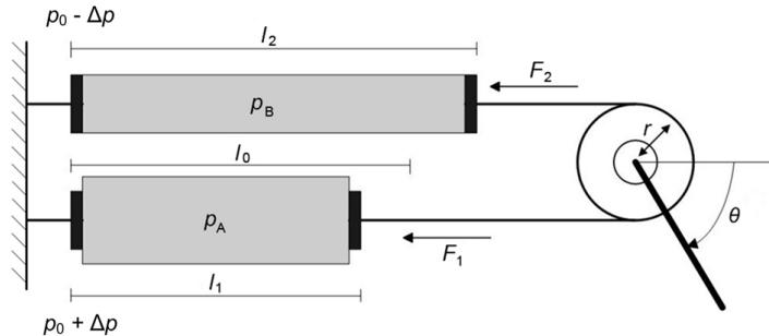
Slika 4.1. Shematski prikaz radnog principa ruke manipulatora
