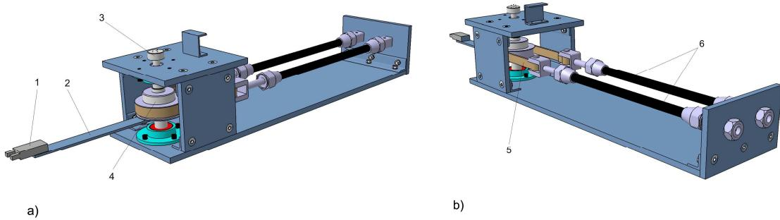
Slika 3.17. CAD model pneumatskog manipulatora, a) i b) [7]
