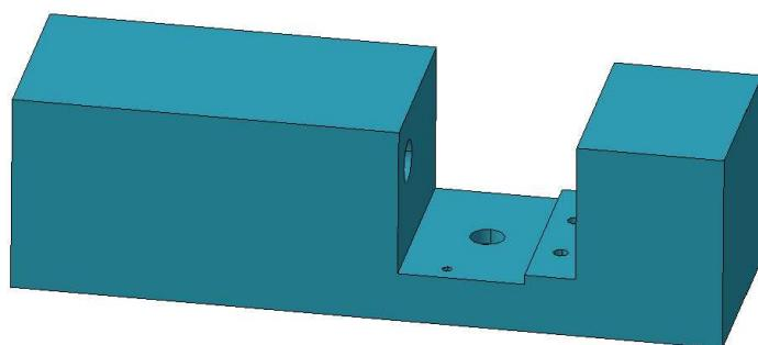
Slika 3.23. CAD model kućišta dodavača (postavljen horizontalno)
