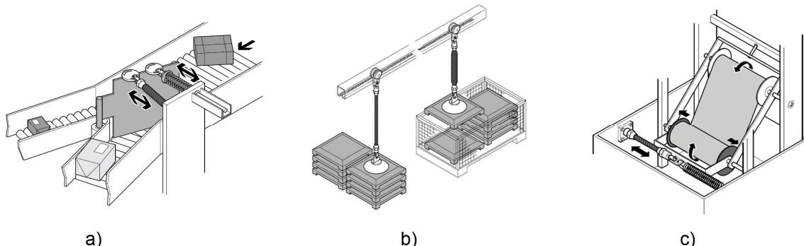
Slika 2.17. Pneumatski mišići u industrijskoj primjeni, a), b) i c) [16]
