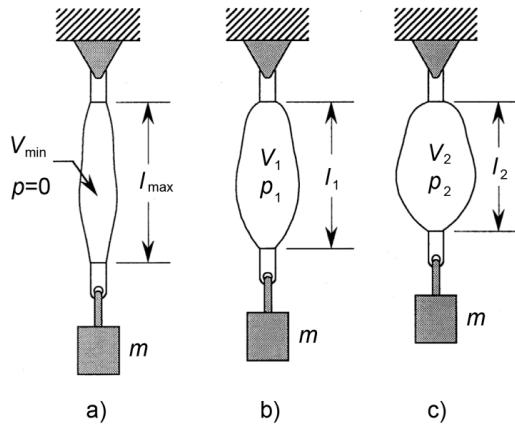
Slika 2.2. Pneumatski mišić u radu prilikom konstantnog opterećenja [6]
