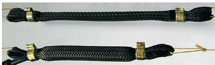
Slika 2.4. McKibbenov pneumatski mišić. Opušten (gore) i napuhan (dolje) [8]
