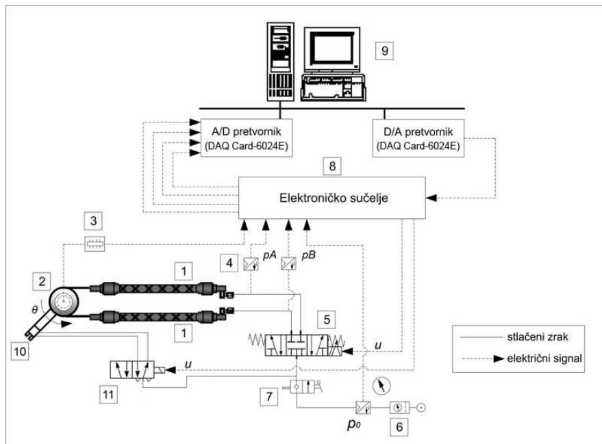
Slika 5.2. Shematski dijagram regulacijskog sustava
