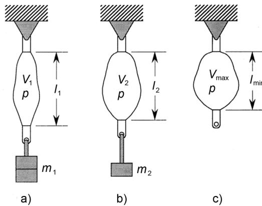
Slika 2.3. Pneumatski mišić u radu prilikom konstantnog tlaka [6]
