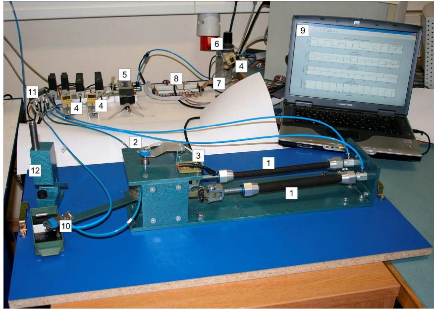
1 – Pneumatski mišić, 2 – Rotacijski potenciometar, 3 – Voltna referenca,
