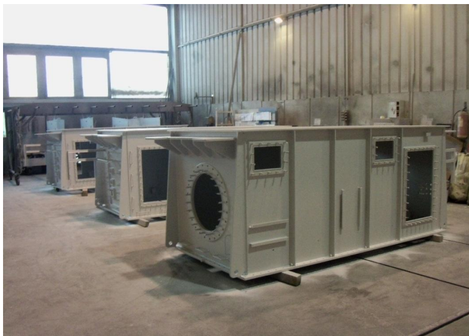
Slika 2. Dvodijelni transformatorski kotao [3]
