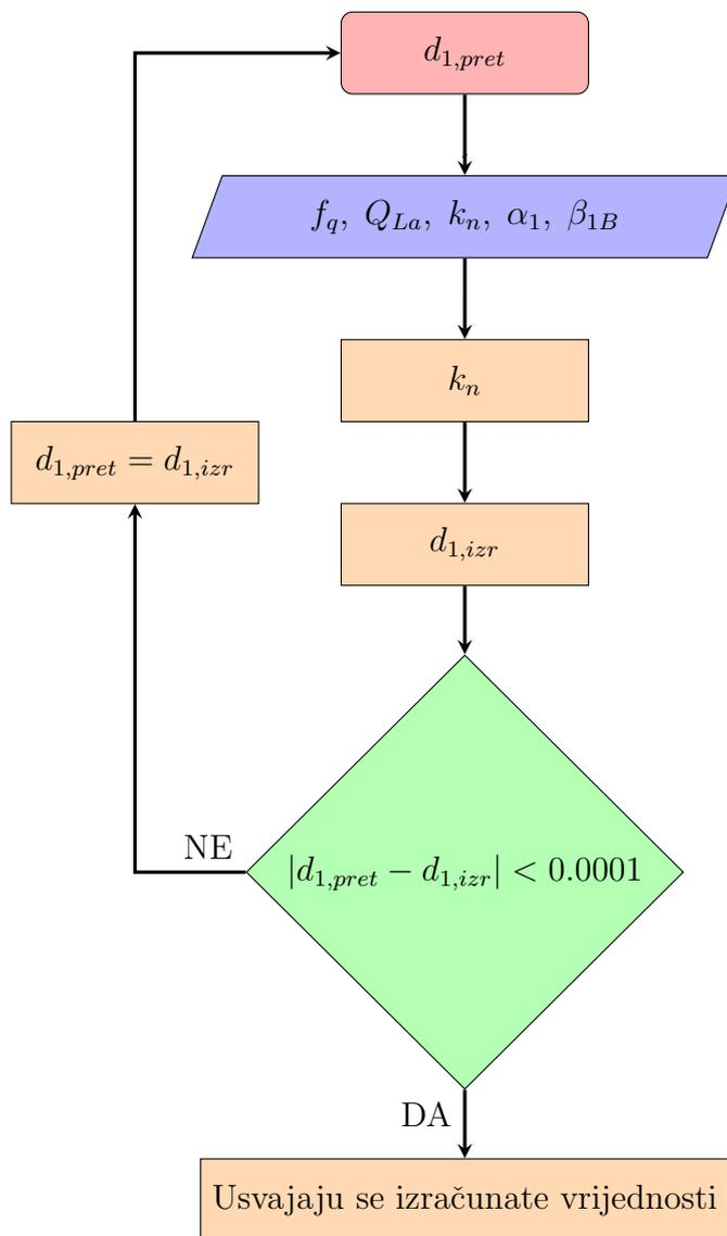
Slika 2.3: Dijagram toka izračuna unutarnjeg promjera pumpe  $d_1$
