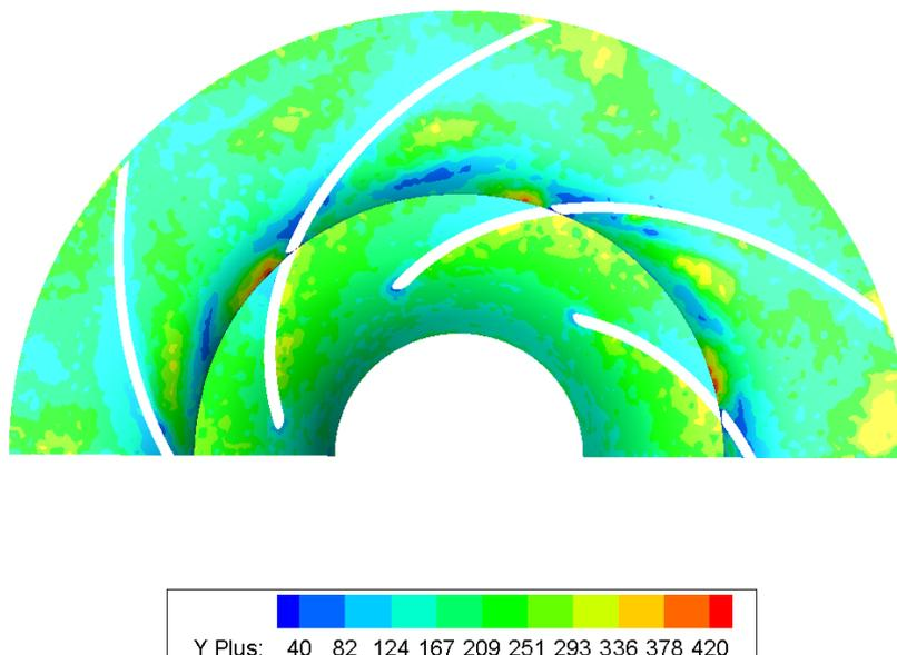
Slika 4.10:  $y^+$  po zidovima rotora pumpe
