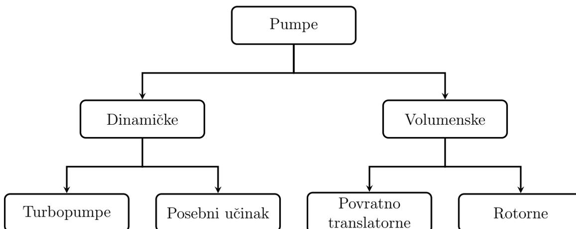
Slika 1.4: Podjela pumpi prema mehanizmu izmjene energije
