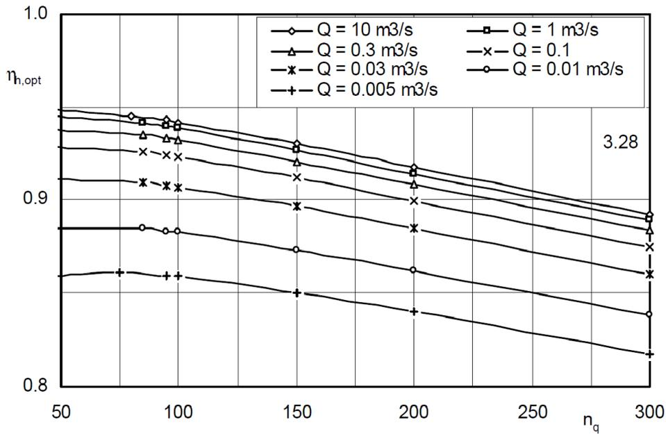
Slika 1.14: Prikaz hidrauličke efikasnosti za aksijalne i poluaksijalne pumpe ovisno o specifičnoj brzini
