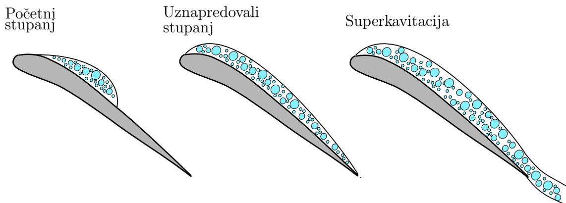
Slika 1.21: Shematski prikaz podjele profilne kavitacije
