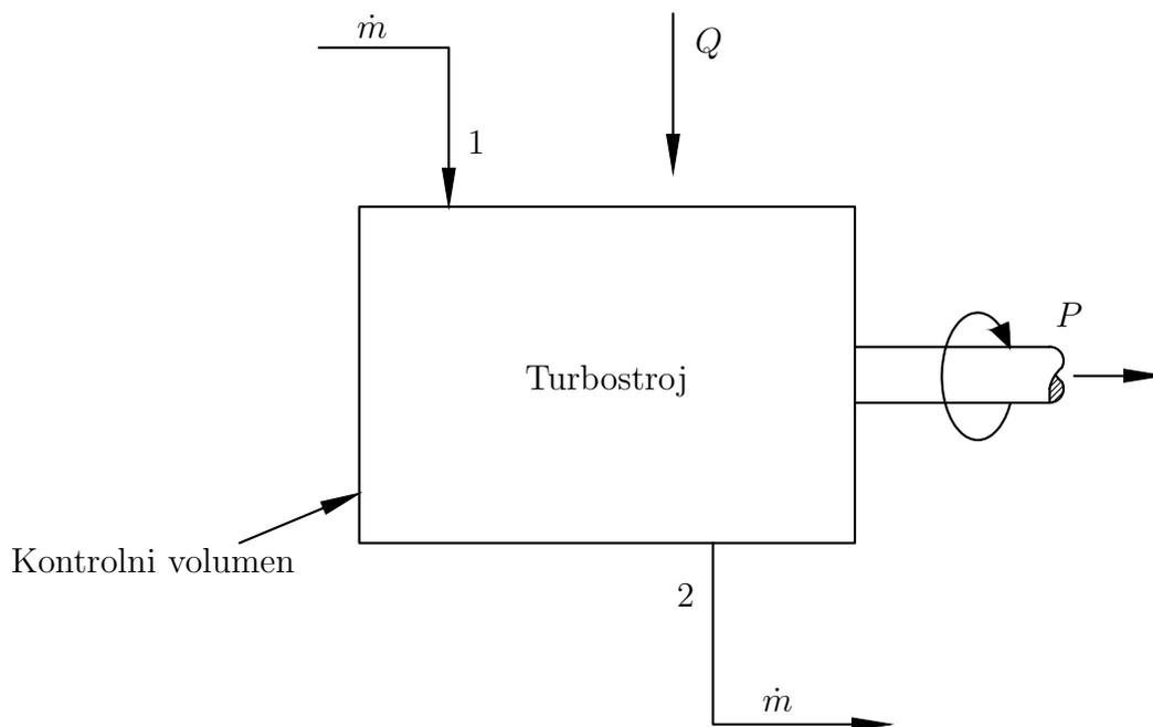
Slika 1.3: Shematski prikaz kontrolnog volumena
