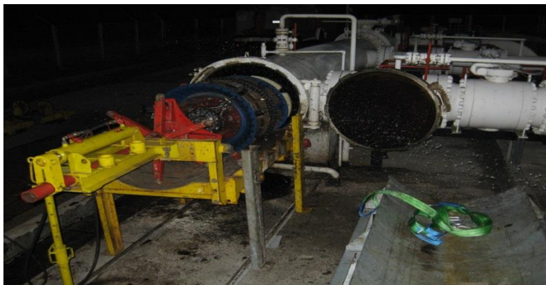
Slika 30. Lansiranje piga u naftovod hidrauličkom prešom, [11]
