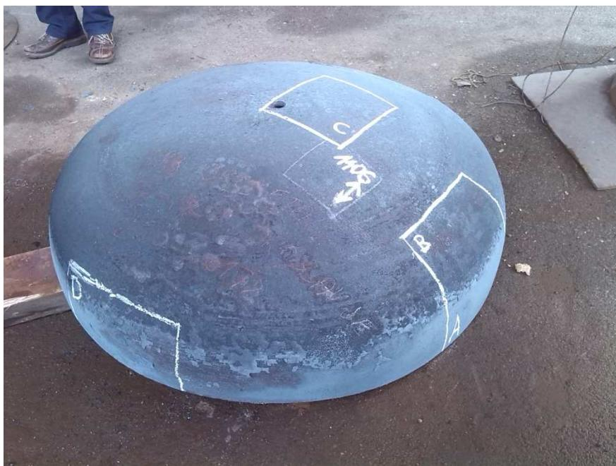
Slika 24. Podnica s označenim uzorcima za ispitivanje
