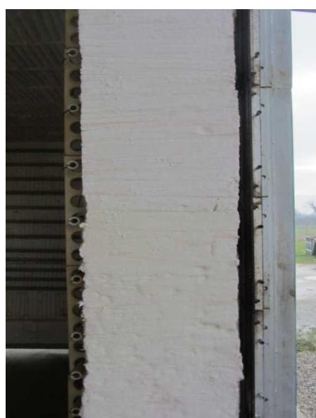
Slika 13. Izolacija peći pomoću keramičkih vlakana
