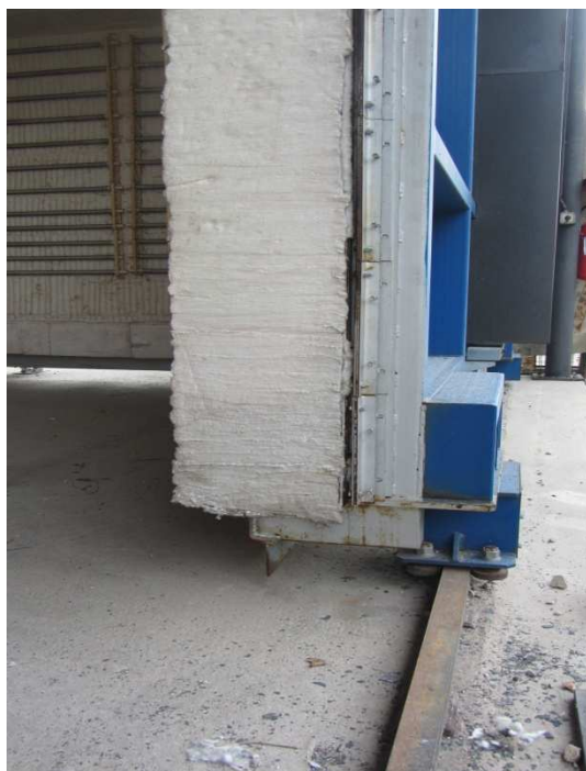
Slika 15. Mehanizam za otvaranje / zatvaranje peći
