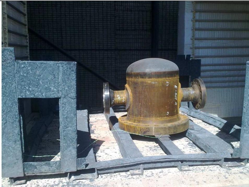
Slika 9. Distributor sa spojenim termoelementom prije žarenja [1]
