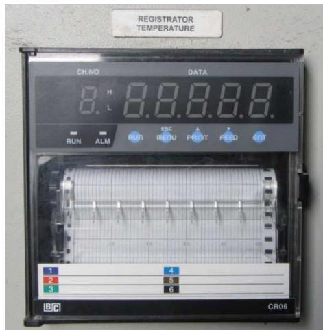
**Slika 21. Registrator temperature s tintnim pisačem**
