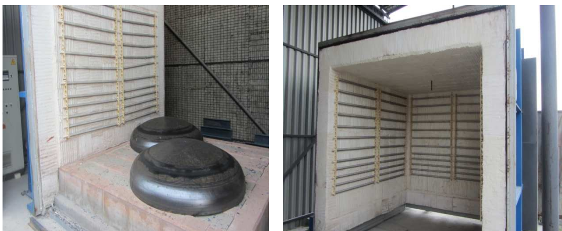
Slika 16. Raspored grijača u peći
