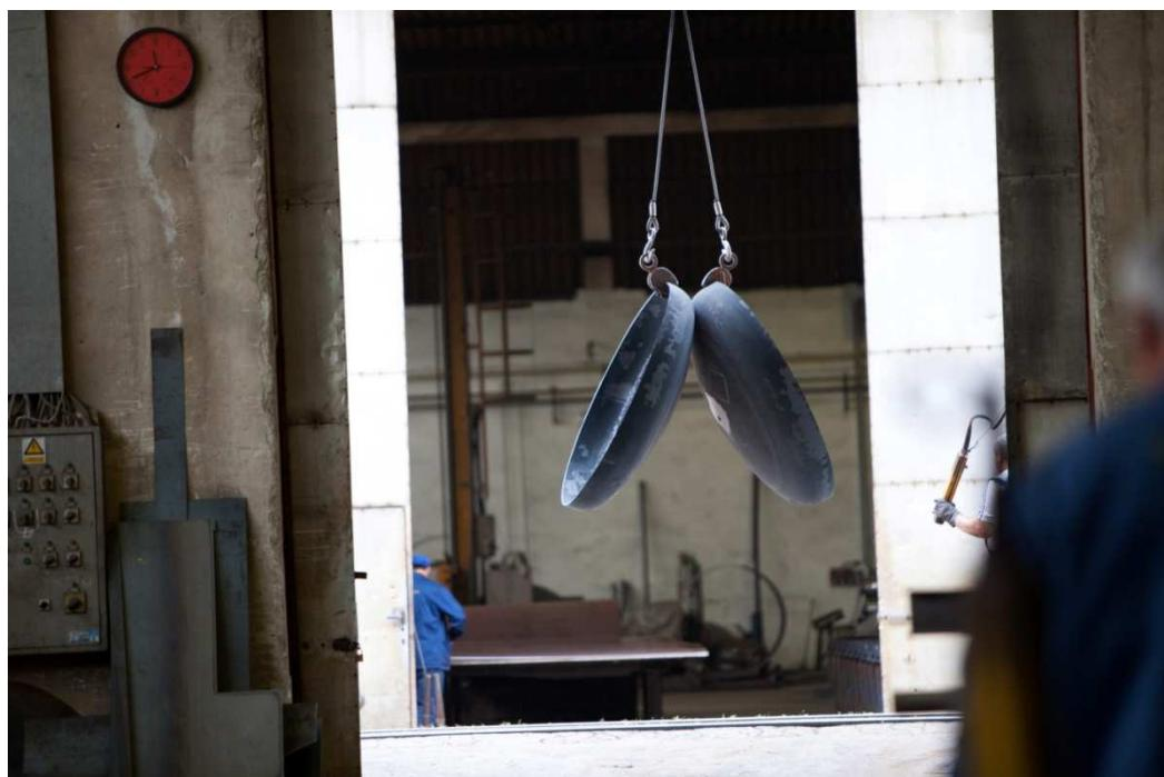
**Slika 3. Podnice izrađene hladnim oblikovanjem spremne za normalizaciju [1]**
