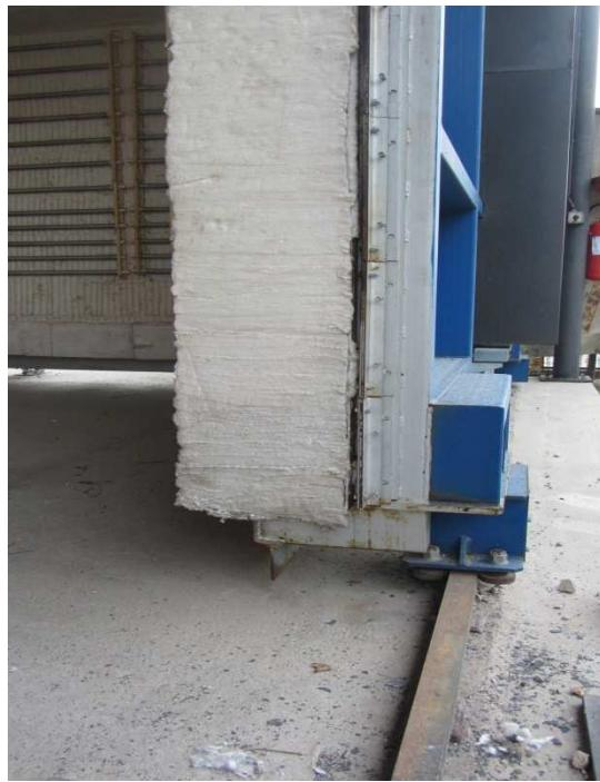
Slika 15. Mehanizam za otvaranje / zatvaranje peći
