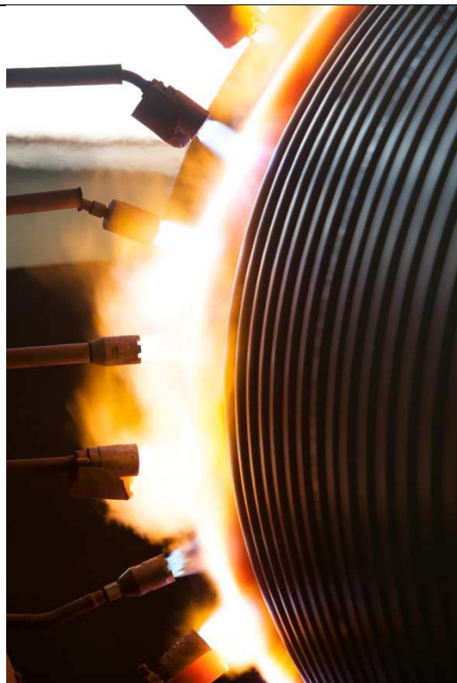
Slika 5. Način zagrijavanja plamenice [1]
