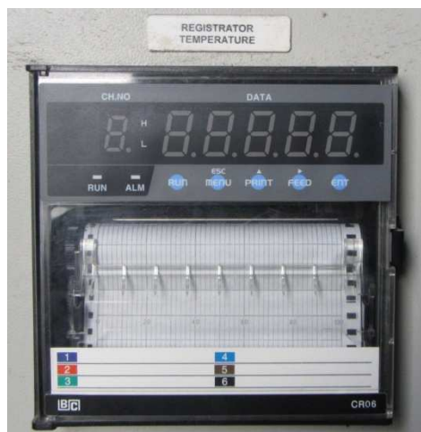
Slika 21. Registrator temperature s tintnim pisačem
