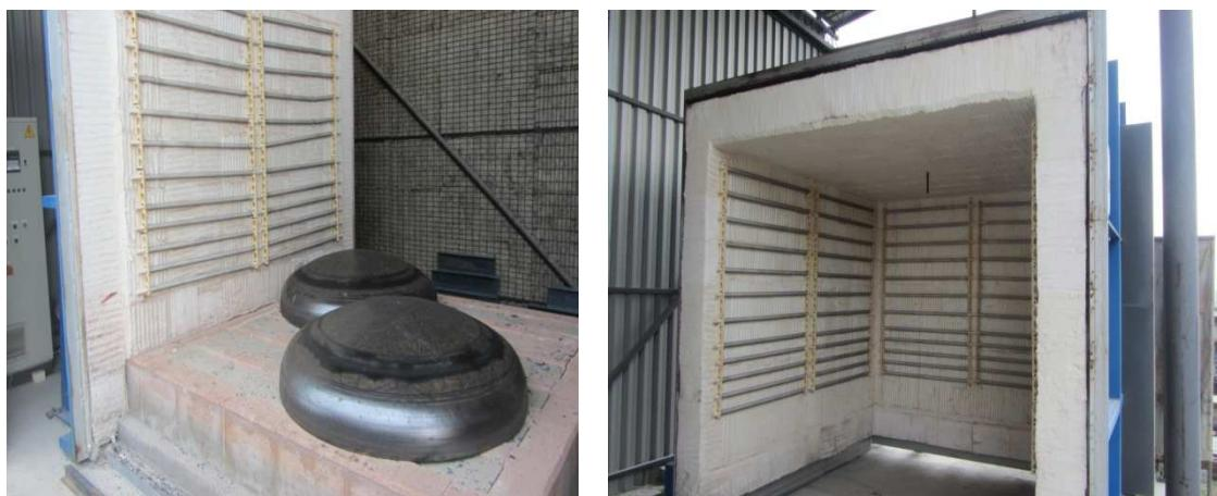
Slika 16. Raspored grijajuća u peći
