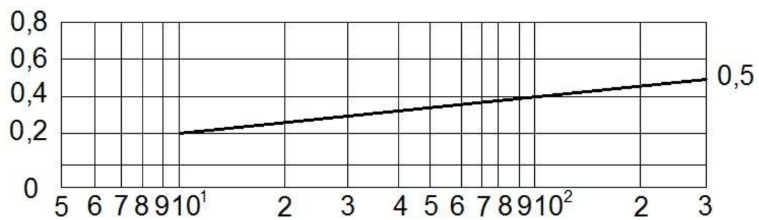
Slika 1. Dijagram maksimalnog pada tlaka prema EN 303-5
