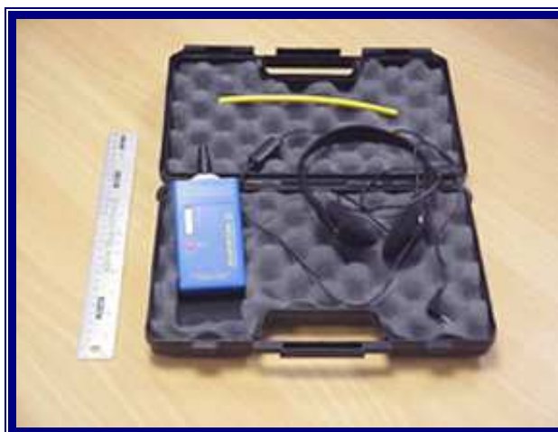
Slika 4.25 Detektor propusnosti vakuuma
