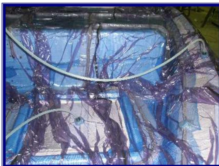
**Slika 4.23** Postavljanje vakuumskih cjevovoda
