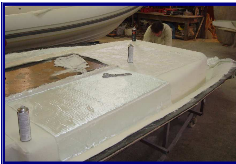
Slika 4.19 Postavljanje završnog sloja laminata palube
