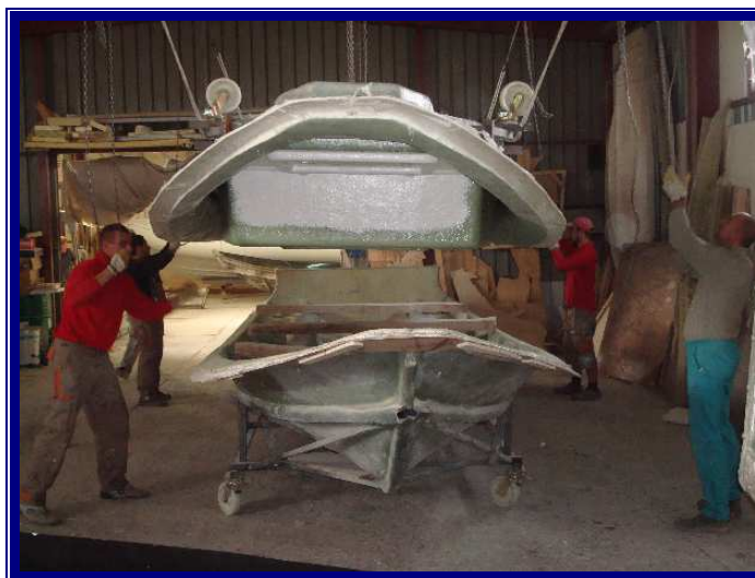
Slika 3.6 Polaganje odljevka palube na odljevak dna
