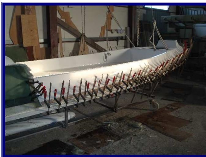
Slika 3.7 Spajanje odljevaka palube i dna
