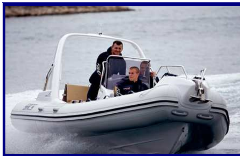
Slika 1.1 Pneumatička brodica sa krutim dnom
