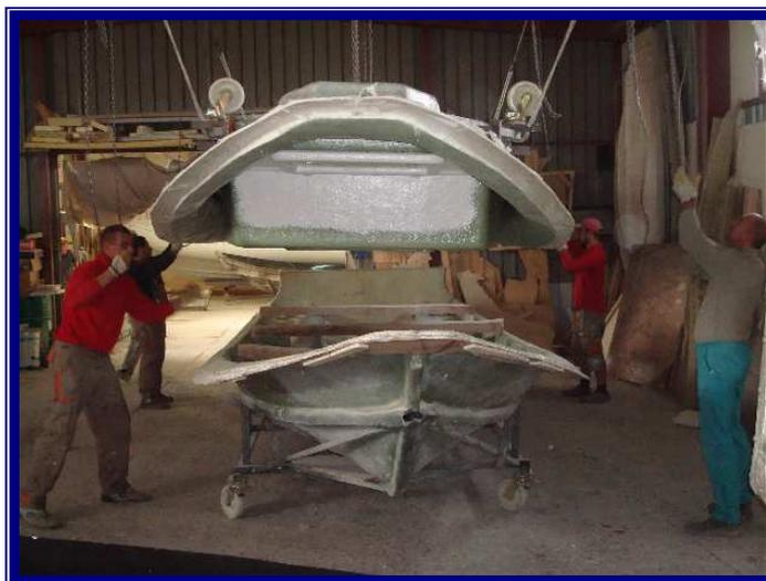
Slika 3.6 Polaganje odljevka palube na odljevak dna
