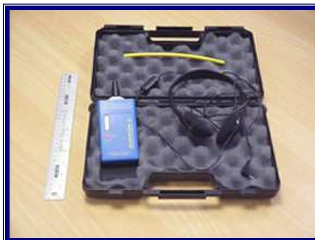
**Slika 4.25 Detektor propusnosti vakuuma**
