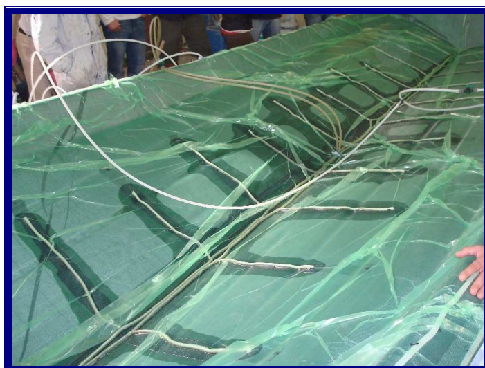
Slika 4.16 Uvođenje smole u laminat
