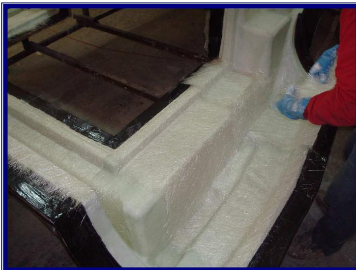
**Slika 4.17** Postavljanje prvog sloja laminata na kalup palube
