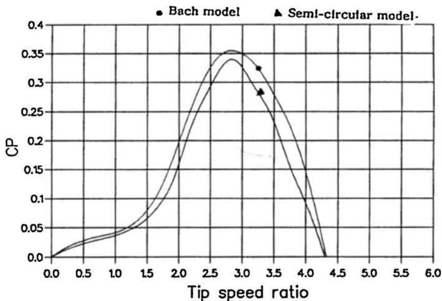
Slika 31. Koeficijenti snage Darrieus Savonius tipa turbine [8]
