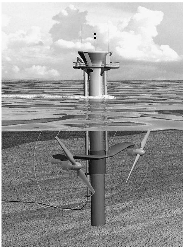
Slika 18. Turbine postavljene na stupu [3]
