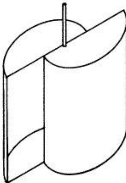
Slika 11. Savoniusova turbina [7]
