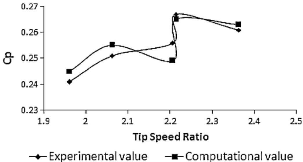
Slika 32. Odnos između koeficijenta snage i TSR-a of H-Darrieus turbine [8]
