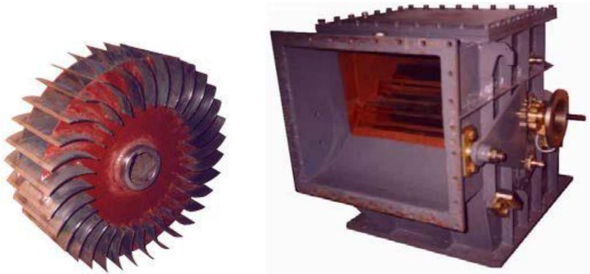
Slika 5. Turbine s osi paralelno s ravninom vode [4]
