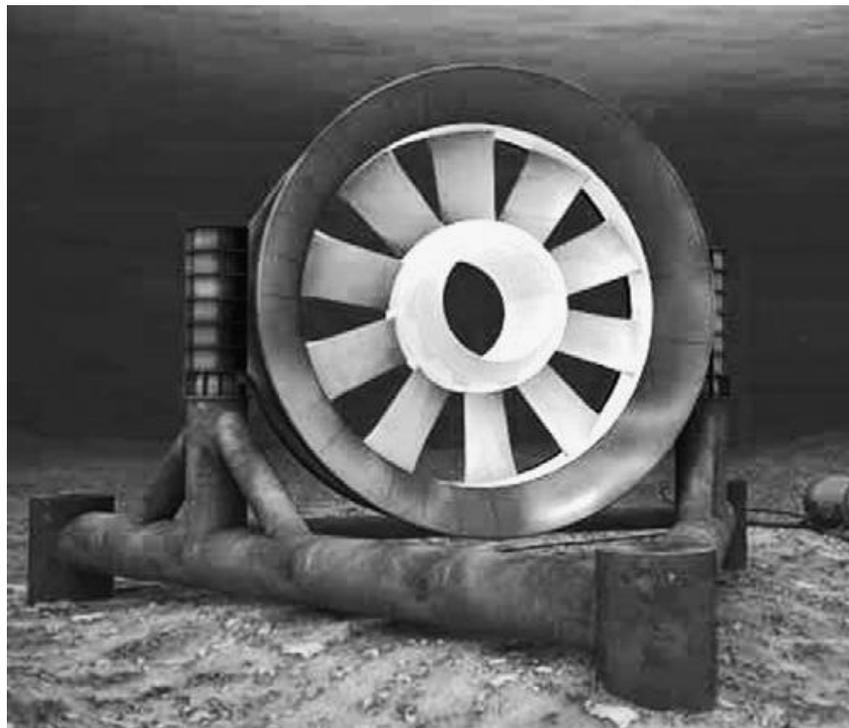
**Slika 3. OpenHydro kinetička turbina [3]**
