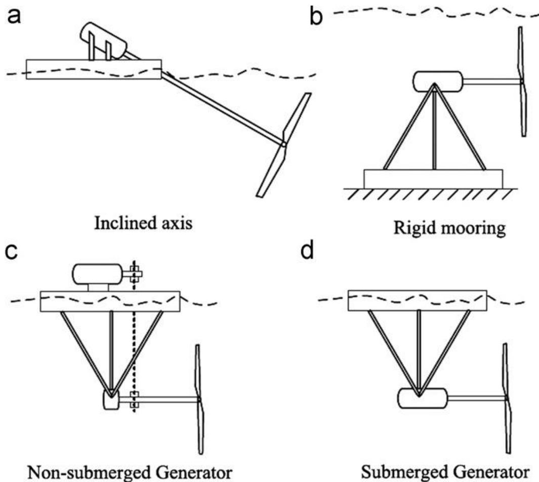
Slika 1. Horizontalne hidroturbine [2]
