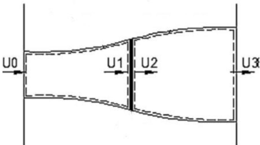
Slika 29. Model rotirajućeg diska kinetičke vodne turbine [8]
