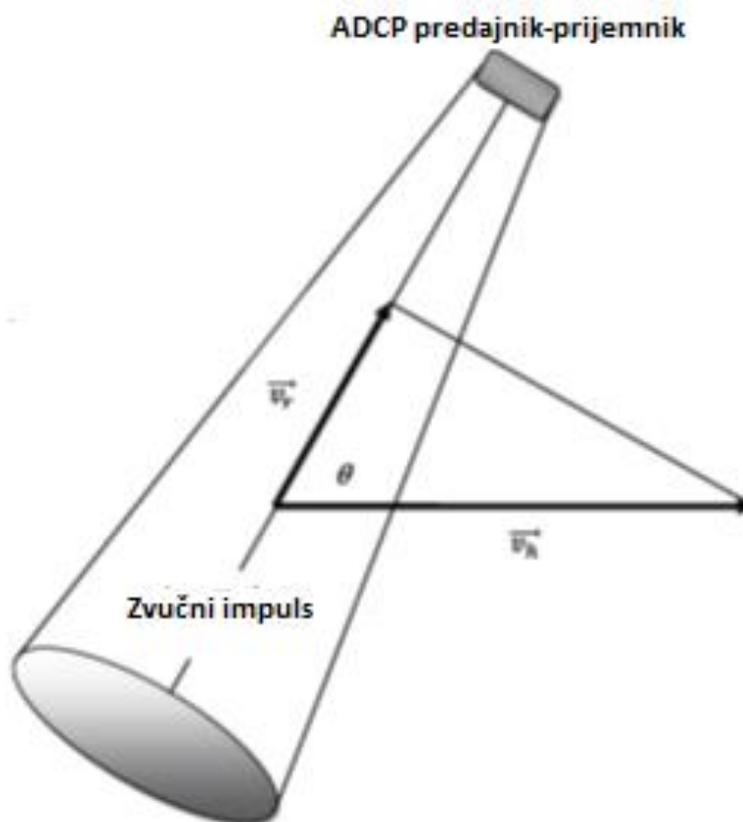
Slika 21. Mjerenje protoka korištenjem ADCP metode [9]
