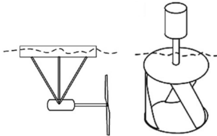
Slika 19. Plutajuće turbine [2]
