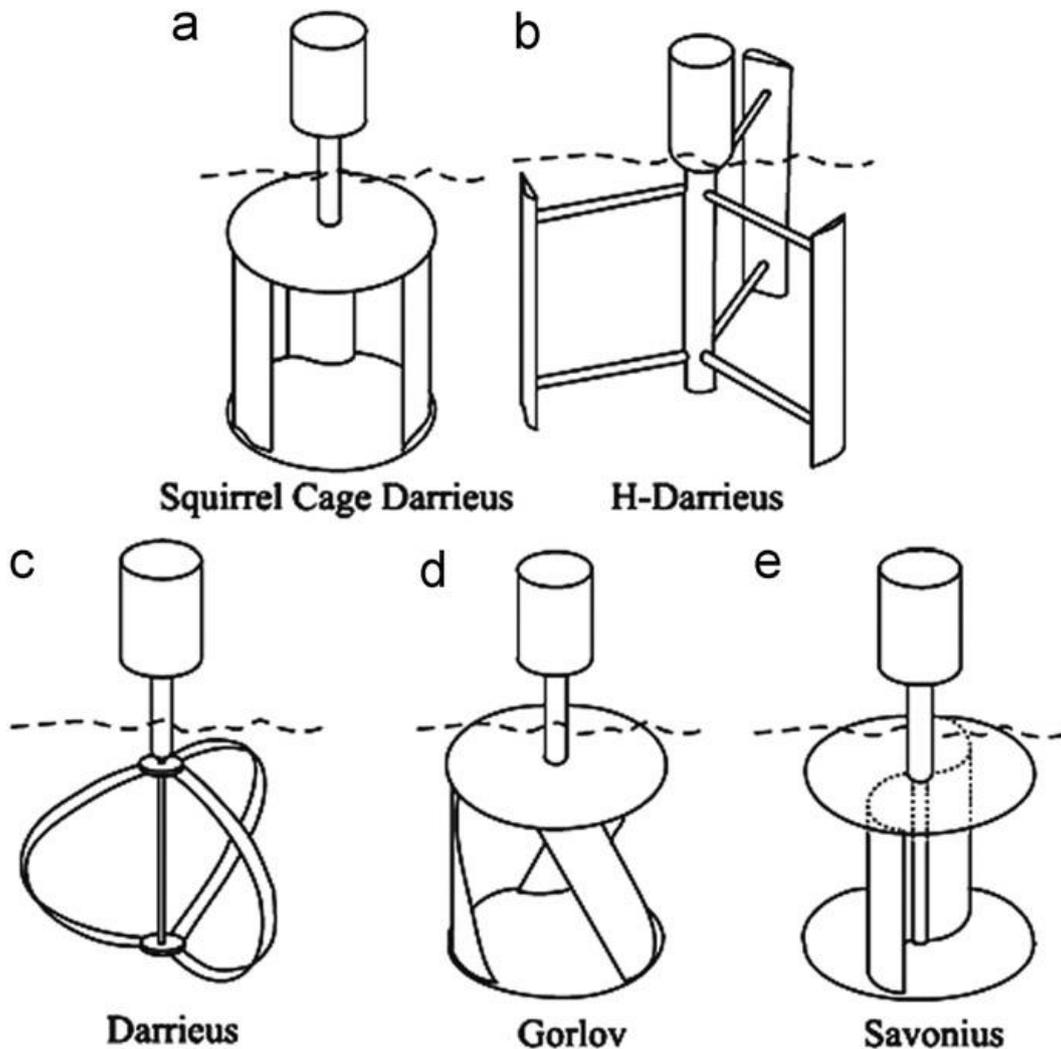
Slika 4. Vertikalnealne turbine [2]
