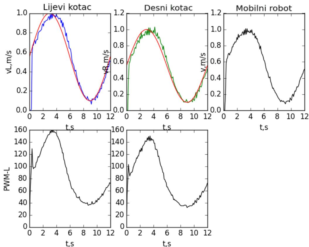
Slika 30. Odziv regulatora sa predfiltracijom brzina (Sinusoida)
