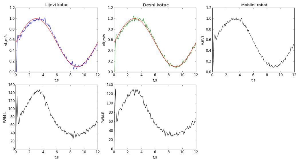
**Slika 31. Odziv PD regulatora uz uvođenje minimalne promjene ulaznih brzina za restiranje koraka filtracije (Sinusoida)**
