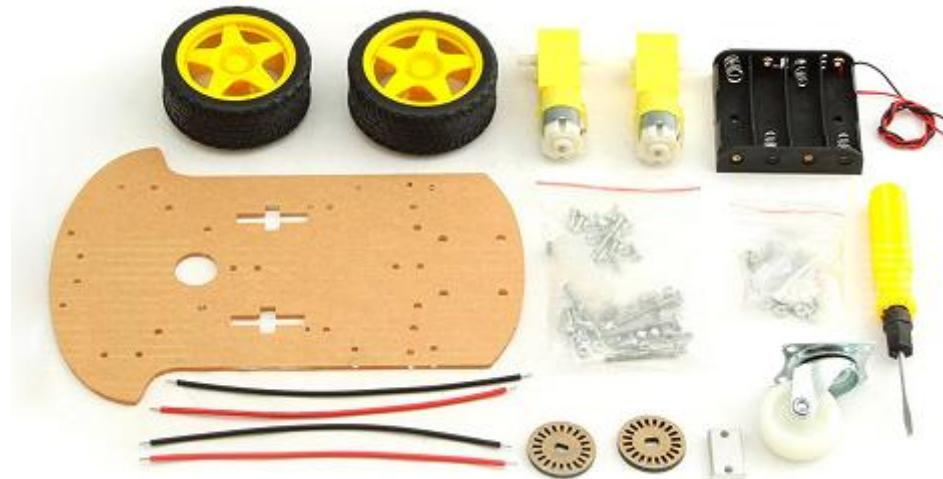
**Slika 7. Donji dio mobilnog robota sa dodatcima**
