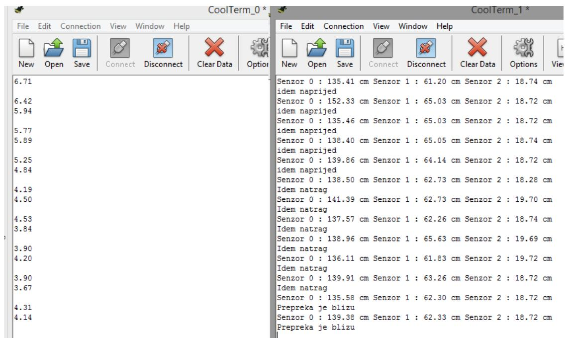
**Slika 25. Ispраван рад stražnjih ultrazvučnih senzora**
