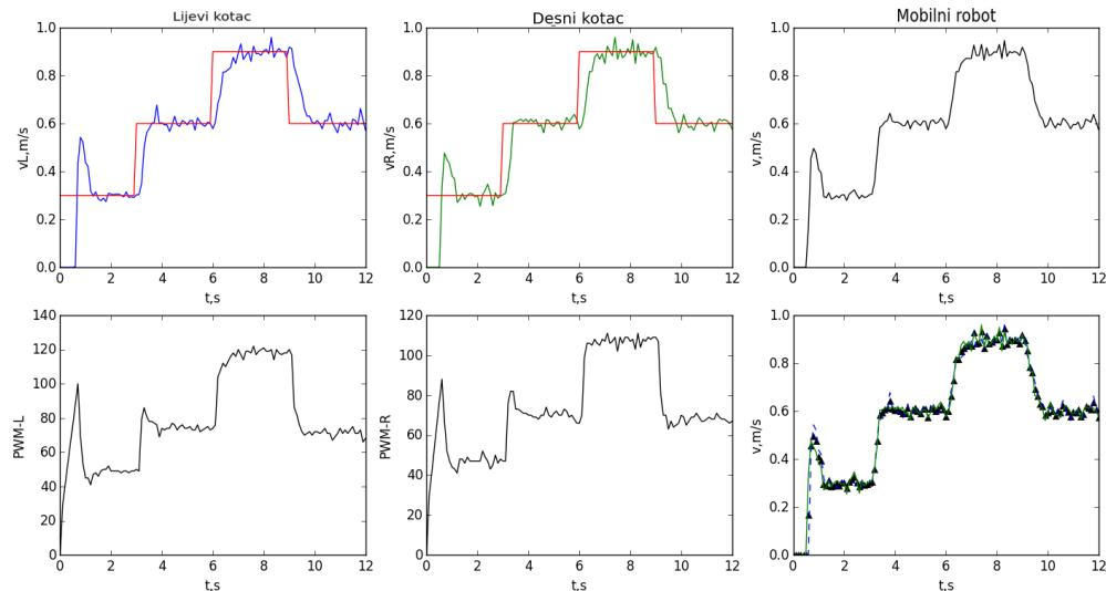
**Slika 29. Odziv regulatora sa predfiltracijom ulaznih brzina (Step)**
