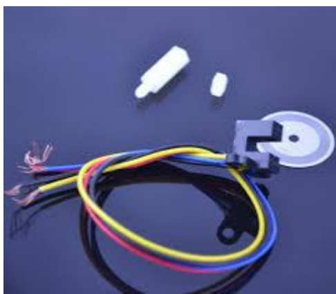
Slika 12. Dvofazni inkrementalni enkoder
