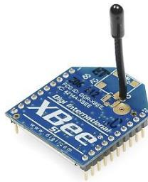
**Slika 20. Xbee 1 mW Wire Antenna Series 1**
