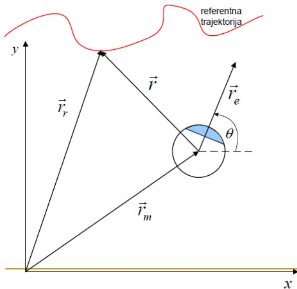
**Slika 3. Mobilni robot u prostoru i referentna trajektorija**
