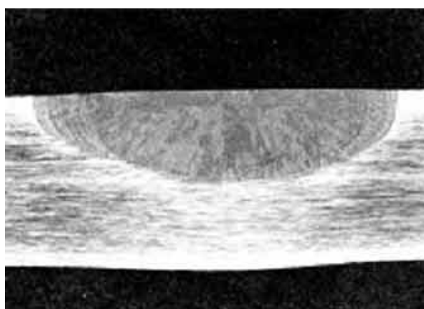
a) Zavar bez A-TIG talila pri 187 [A], 11 [V], 100 [mm/min], 1,23 [kJ/mm]
