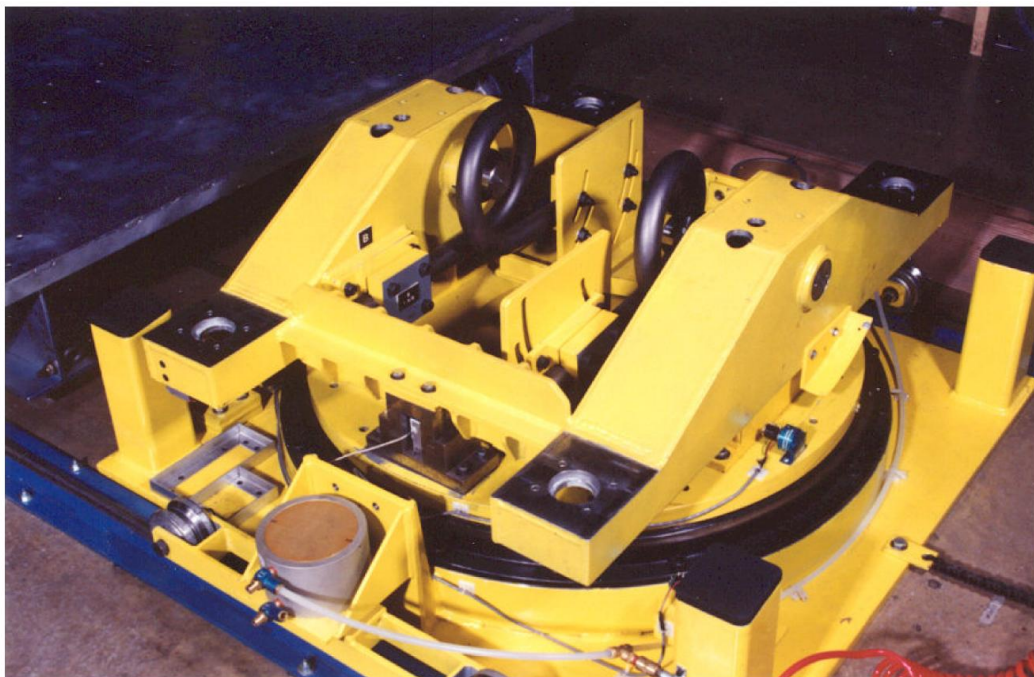
Slika 36. Sklop za mjerenje momenta tromosti oko osi X i Z
