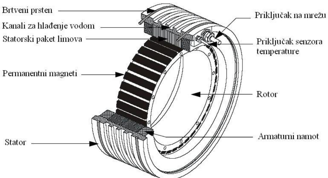
Slika 44. Glavni dijelovi momentnog motora serije TMB tvrtke ETEL [25.]
