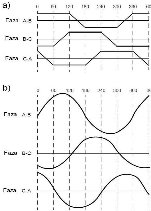
Slika 28. Inducirana elektromotorna sila BLDC elektromotora [9.]:
