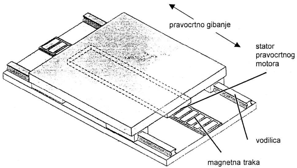
Slika 38. Princip izvedbe direktnog linearнog servo prigona [13.]
