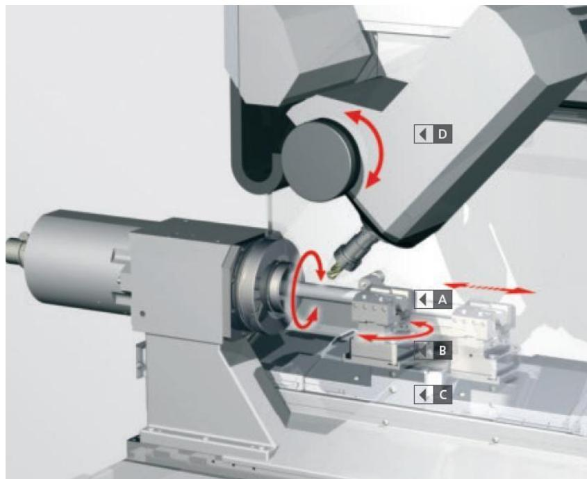
Slika 50. Princip zakretanja osi glavnog vretena na stroju
