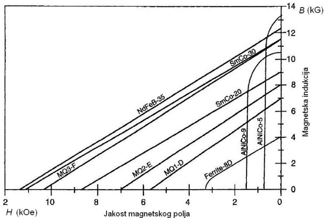
Slika 19.  $B$ - $H$  karakteristika najčešćih permanentnih magneta [5.]
