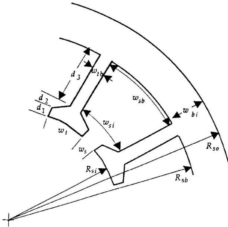
Slika 55. Skica dijela statora sa dimenzijama [5.]
