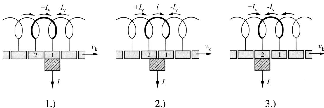
Slika 27. Tri karakteristična trenutka procesa mehaničke komutacije [1.]
