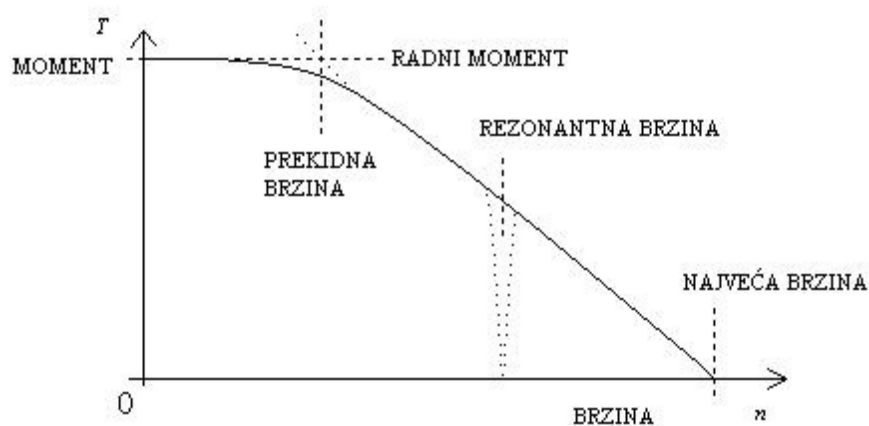
Slika 33. Karakteristika momenta u ovisnosti o brzini vrtnje rotora koračnog motora
