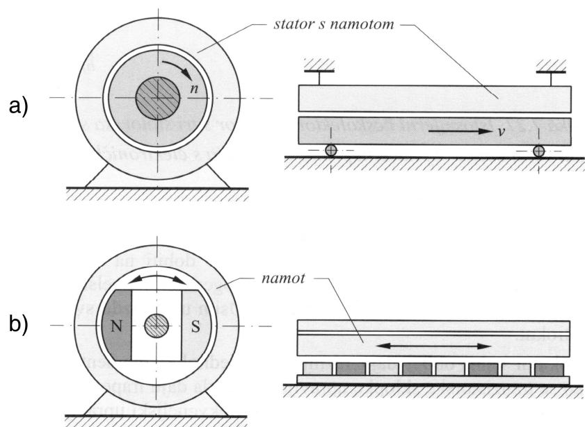
Slika 40. Prikaz nastanka linearnih motora iz rotacijskih [1.]
