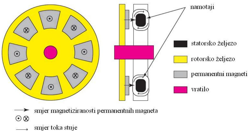
Slika 25. Elektromotor s PM sa aksijalnim magnetskim tokom [6.]
