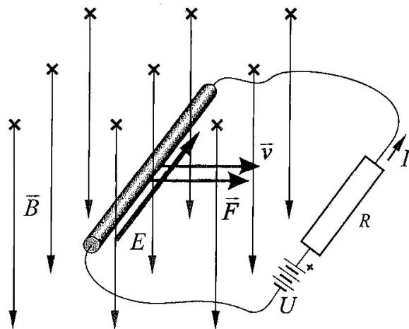
Slika 5. Prikaz pretvorbe električne energije u mehaničku [1.]
