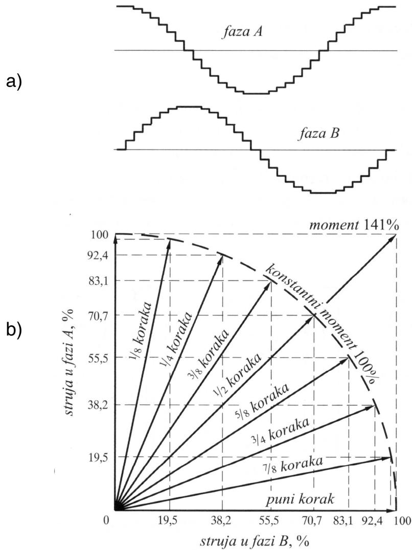
Slika 34. Načelo rada mikrokoraka koračnog elektromotora [1.]
