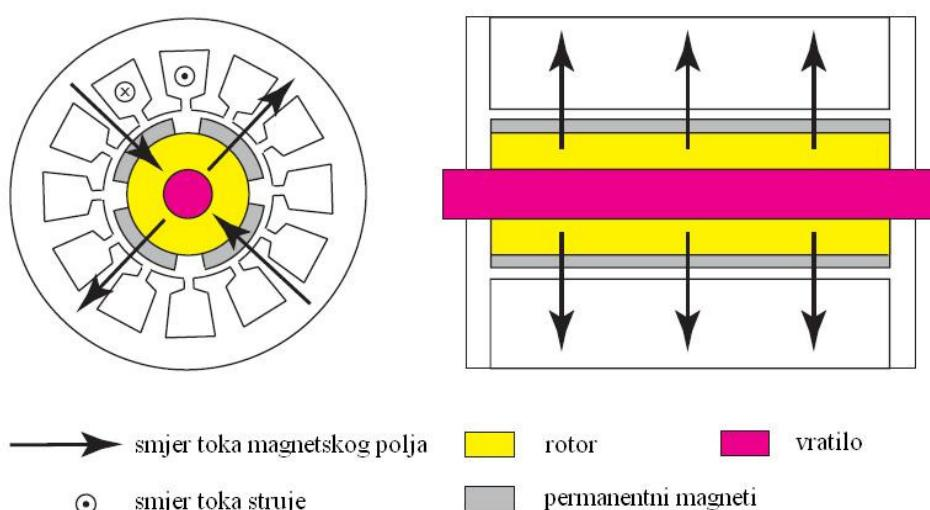
Slika 20. Elektromotor s PM sa radijalnim magnetskim tokom [6.]
