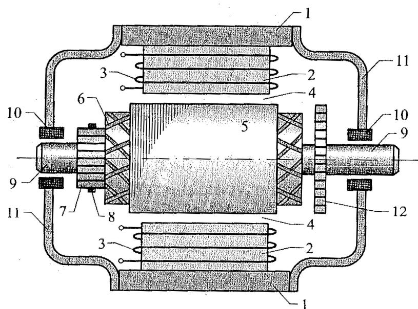
Slika 12. Pojednostavljeni prikaz istosmjernog motora za manje snage [1.]
