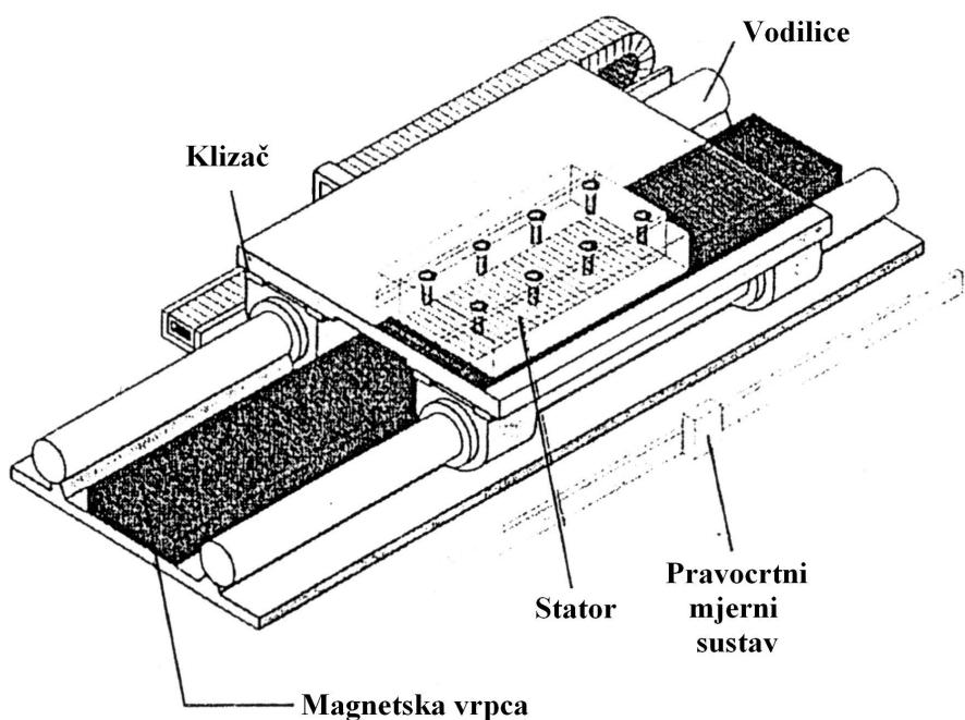
Slika 42. Direktni linearni servo prigon sa dvijema vodilicama [13.]
