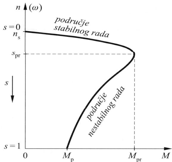
Slika 15. Vanjska karakteristika asinkronog elektromotora  $n = f(M)$  [1.]
