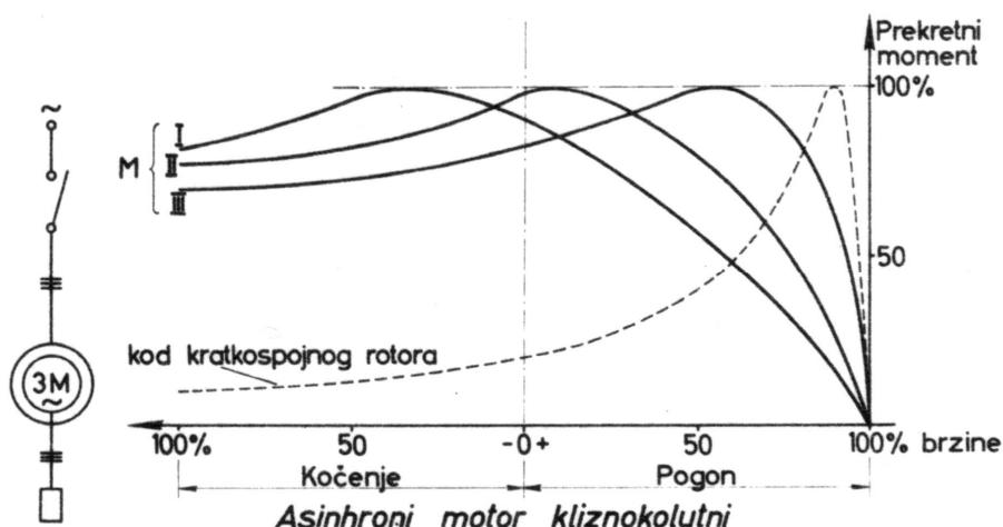
Slika 17. Radna karakteristika asinkronog kliznokolutnog elektromotora [7.]
