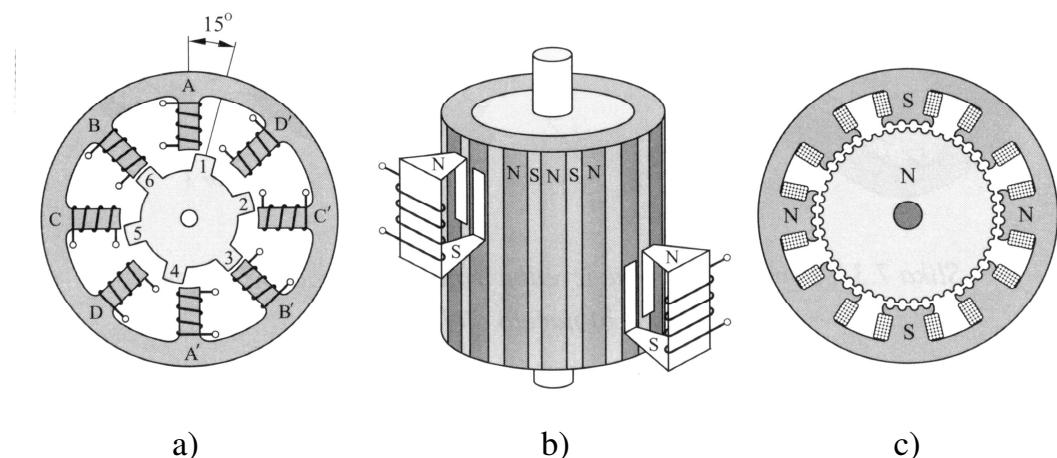
Slika 32. Prikaz osnovnih vrsta koračnih elektromotora [1.]:
