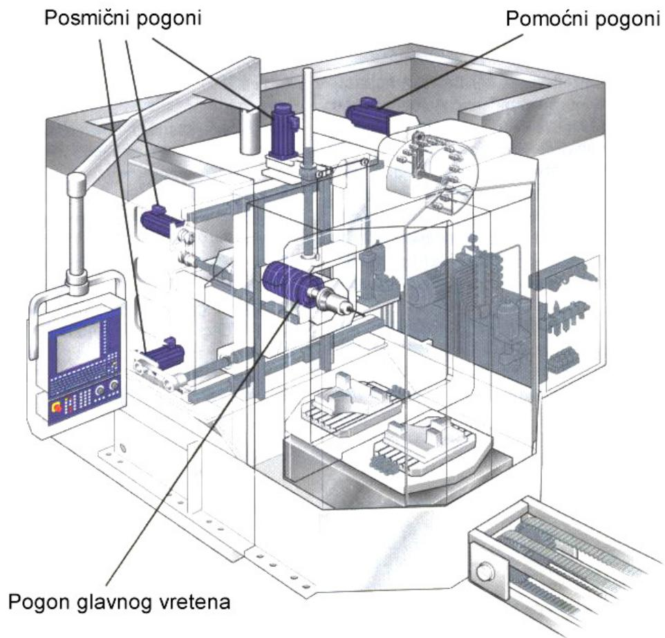
Slika 36. Prikaz podjele pogona na horizontalnom obradnom centru [14.]
