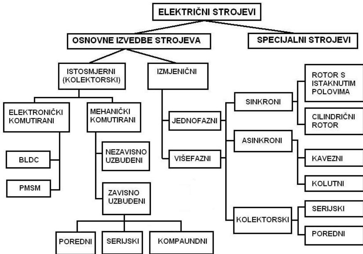
Slika 11. Podjela električnih strojeva
