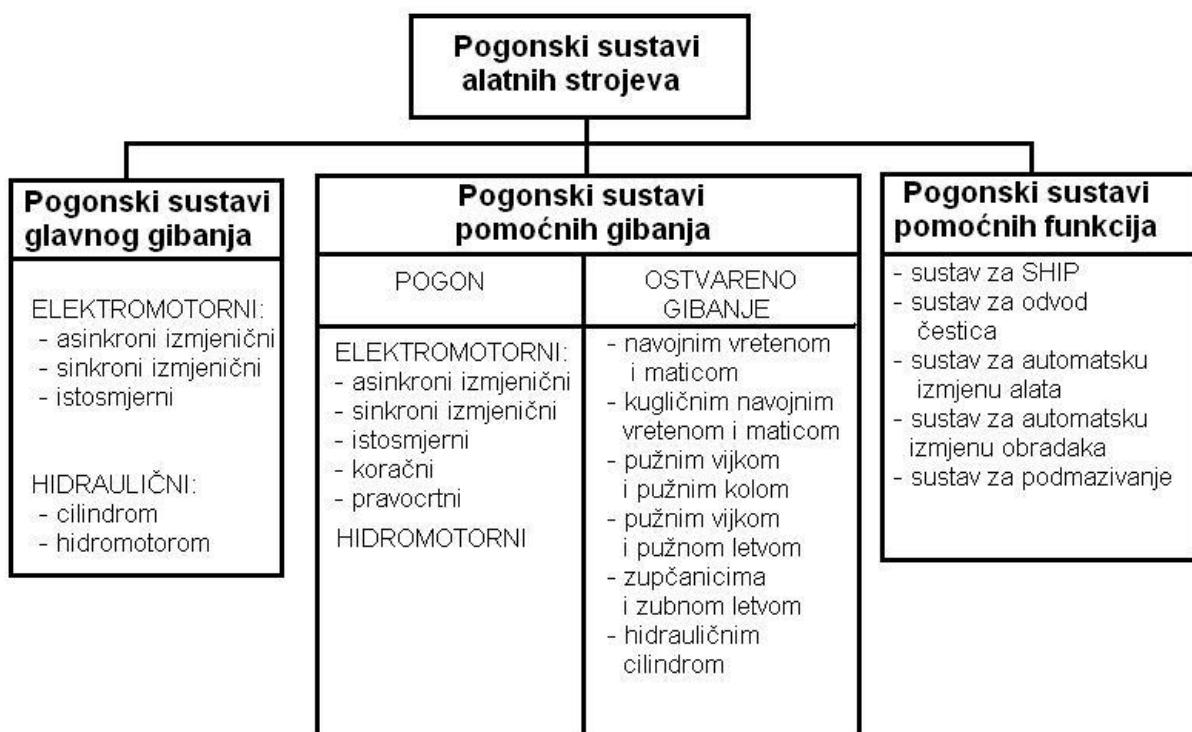
Slika 35. Pogonski sustavi alatnih strojeva [13.]
