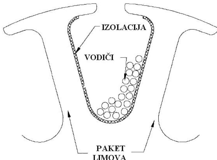
Slika 8. Presjek jednog utora rotorskog paketa limova [5.]
