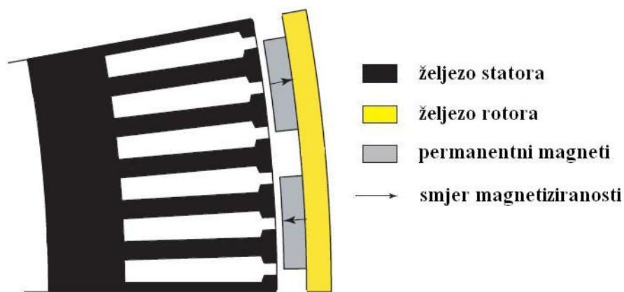
Slika 22. Poprečni presjek SMPM elektromotor sa vanjskim rotorom [6.]
