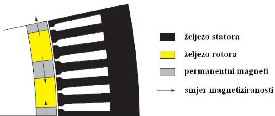
Slika 24. Poprečni presjek elekromotora sa tangencijalno magnetiziranim permanentnim magnetima [6.]
