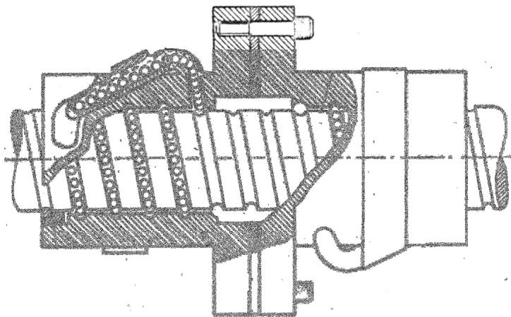
Slika 37. Presjek sklopa kugličnog navojnog vretena i dvostrukе maticе [7.]
