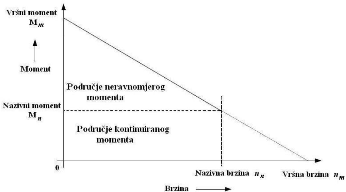
Slika 31. Dijagram karakteristike momenta BLDC elektromotora
