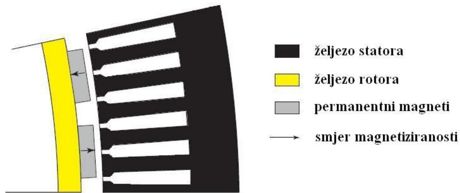
Slika 21. Poprečni presjek SMPM elektromotora sa unutarnjim rotorom [6.]
