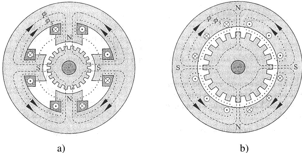
Slika 9. Primjeri magnetskog kruga u elektromotoru [1.]
