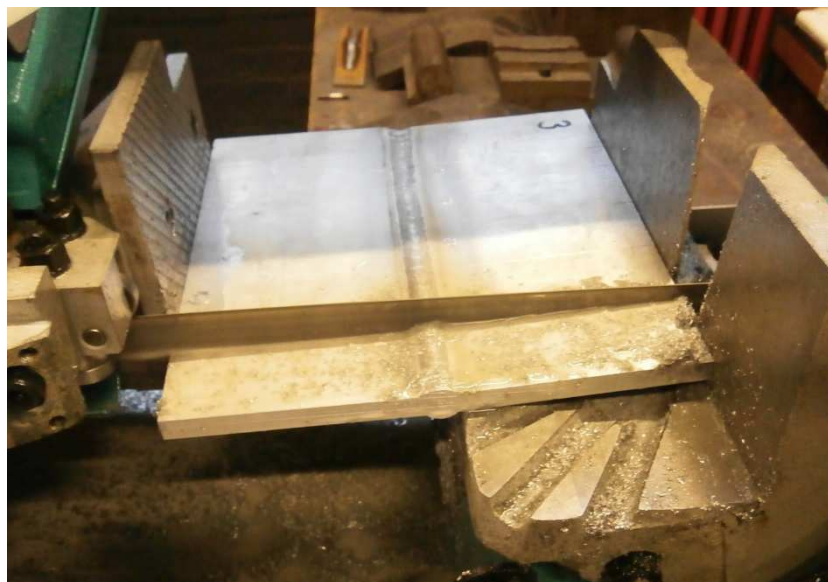
Slika 36. Rezanje uzoraka na tračnoj pili
