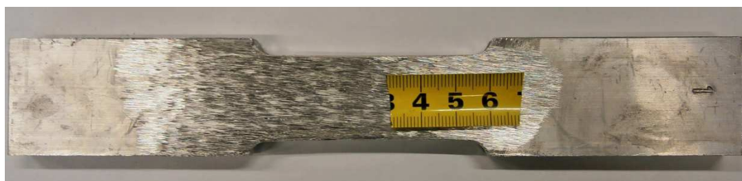
Slika 52. Epruveta za statički vlačni pokus
