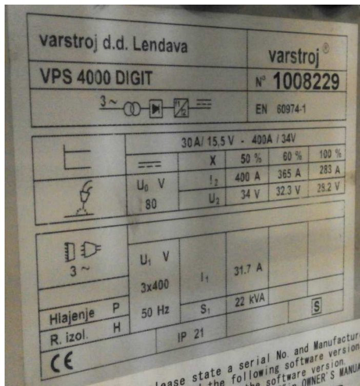
Slika 26. Identifikacijska pločica uređaja
