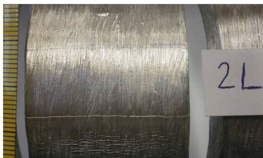
Slika 40. Uzorak 2 – lice zavora opterećeno na vlak
