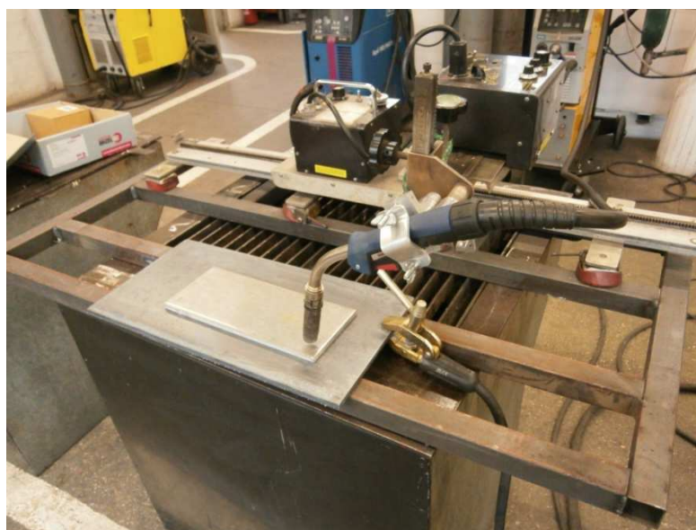
Slika 28. Prikaz automata i konstrukcije za vođenje pištolja
