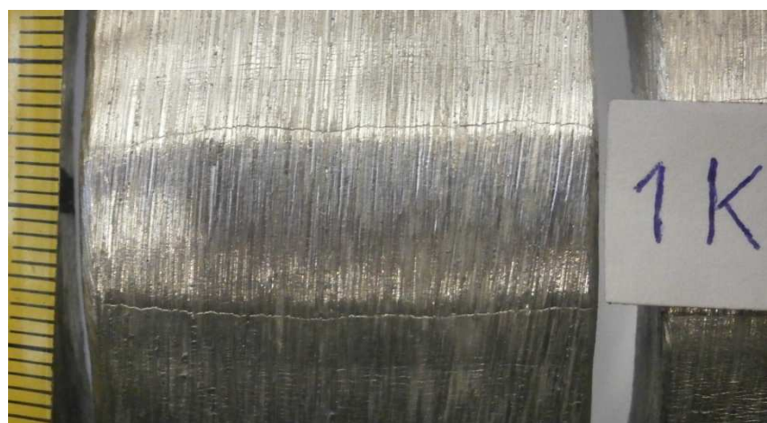
Slika 39. Uzorak 1 – korijen zavora opterećen na vlak
