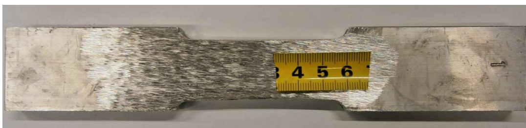
Slika 52. Epruveta za statički vlačni pokus
