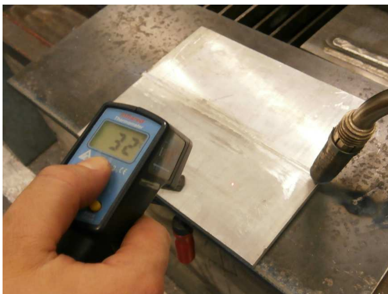
Slika 30. Mjerenje temperature između prolaza
