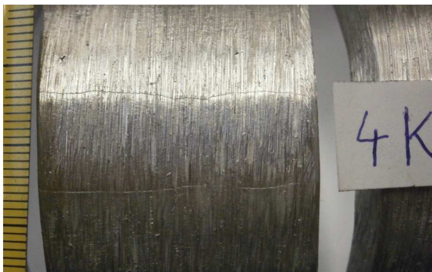
Slika 45. Uzorak 4 – korijen zavora opterećen na vlak
