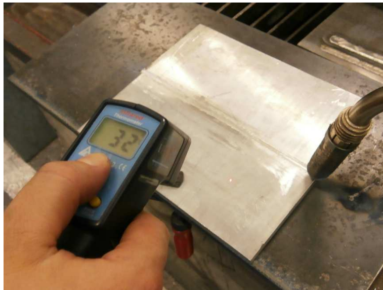
Slika 30. Mjerenje temperature između prolaza
