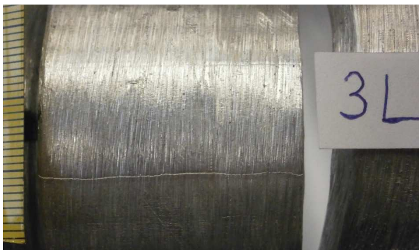
Slika 42. Uzorak 3 – lice zavara opterećeno na vlak
