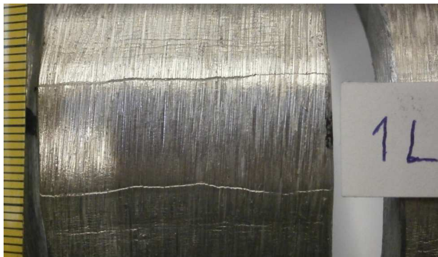
Slika 38. Uzorak 1 – lice zavora opterećeno na vlak
