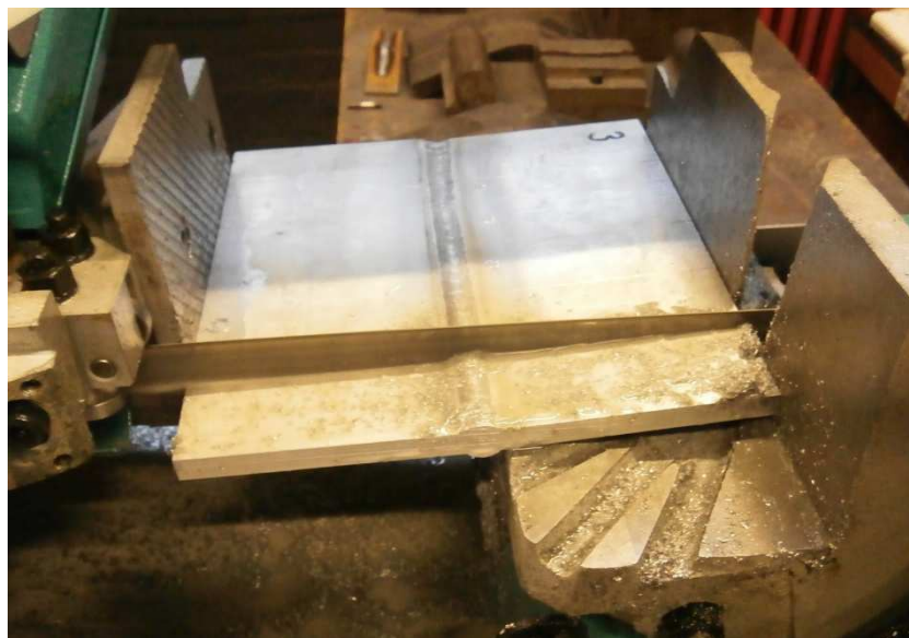
Slika 36. Rezanje uzoraka na tračnoj pili
