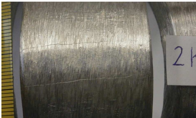
Slika 41. Uzorak 2 – korijen zavara opterećen na vlak
