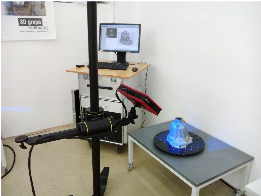
Slika 81. Ručni način digitalizacije mjernog uzorka
