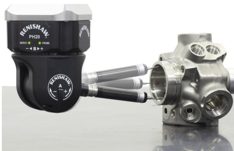
Slika 9. Mjerna glava Renishaw PH20 sa ticalom
