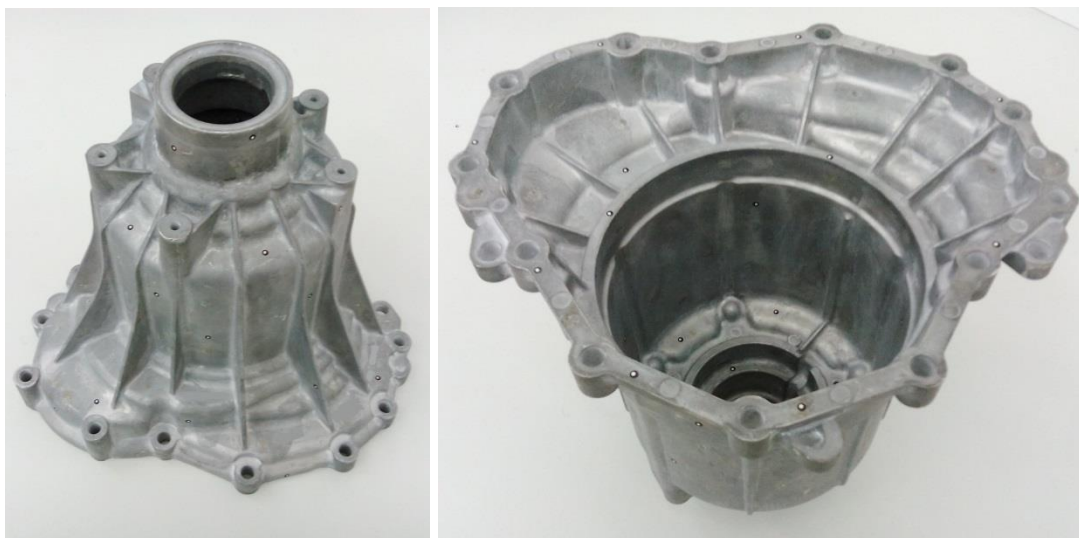
Slika 25. Mjerni uzorak sa referentnim točkama
