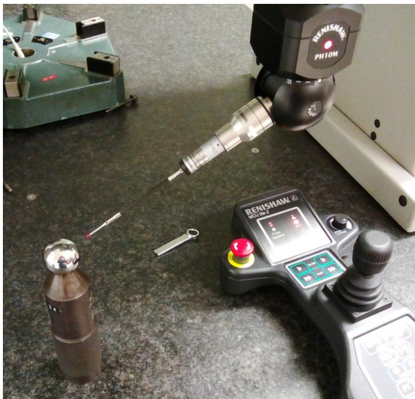
Slika 29. Postupak kalibracije TMU
