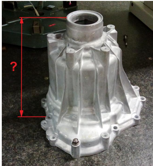
Slika 66. Problem kod mjerenja gabaritnih mjera
