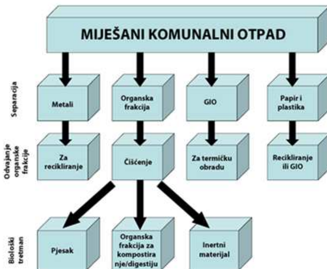
Slika 12. Shema procesa unutar postrojenja za MBO
