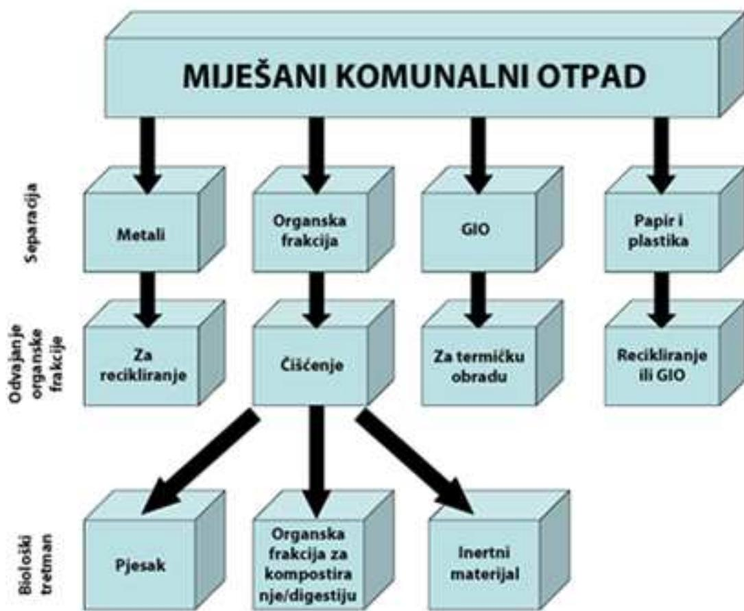
Slika 12. Shema procesa unutar postrojenja za MBO
