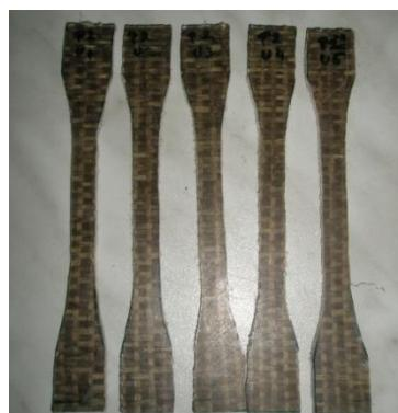
Slika 22. Epruvete kompozita
