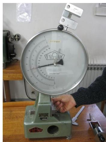
Slika 27. Charpy-ev bat za mjerjenje udarnog rada loma
