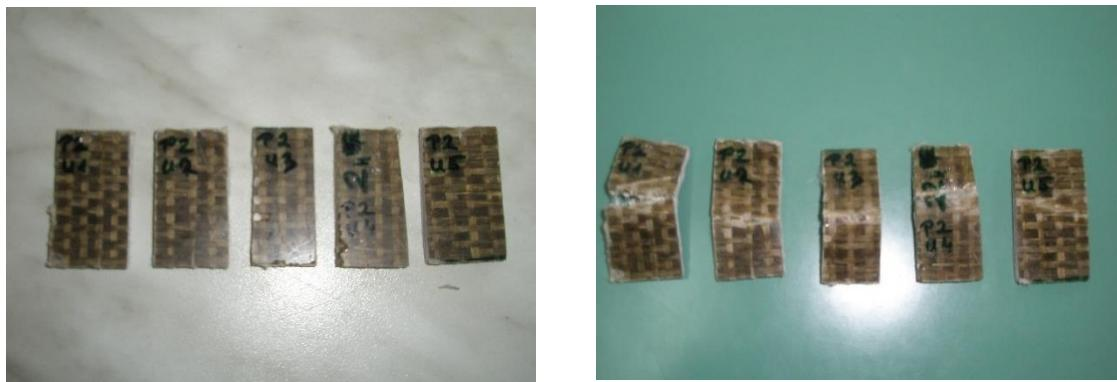
Slika 26. Epruvete prije i poslije ispitivanja međuslojne čvrstoće
