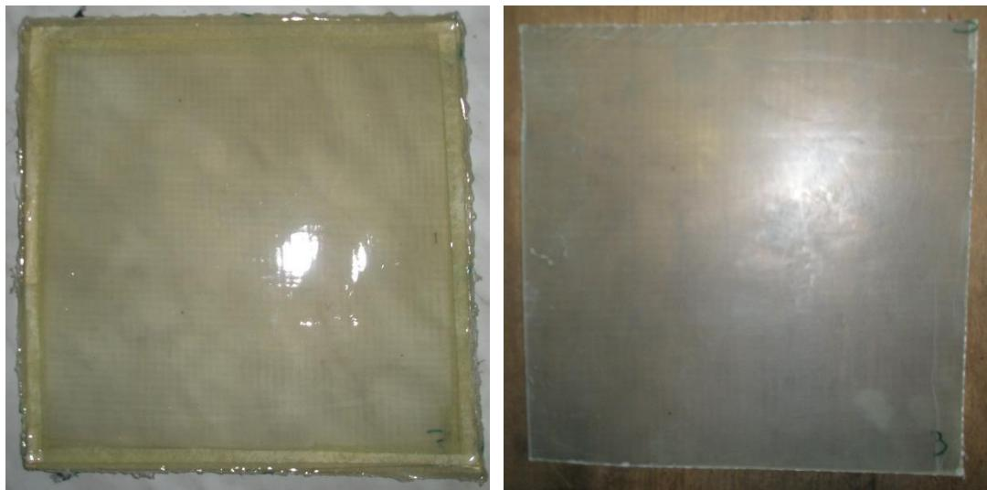
Slika 29. Lijevo- kompozitna ploča, desno-kompozitna ploča bez rubova
