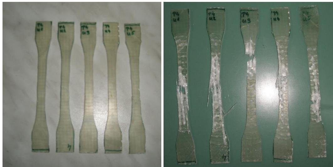
Slika 38. Epruvete prije i poslije ispitivanja rastezne čvrstoće
