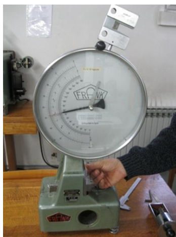
Slika 27. Charpy-ev bat za mjerenje udarnog rada loma
