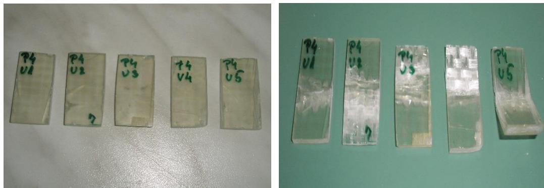
Slika 43. Epruvete prije i poslije ispitivanja međuslojne čvrstoće
