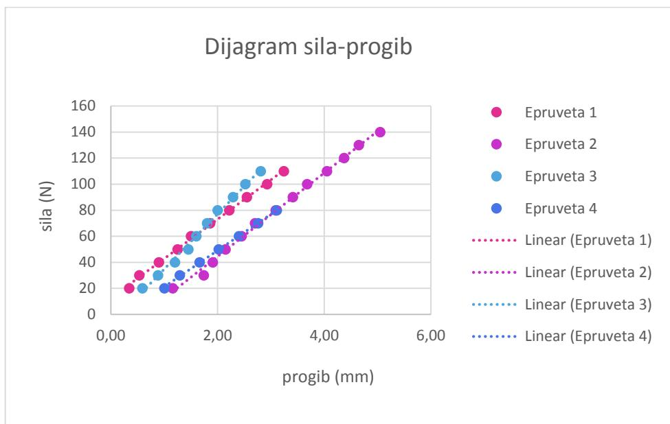
Slika 42. Dijagram ovisnosti produljenja o opterećenju za uzorak 3
