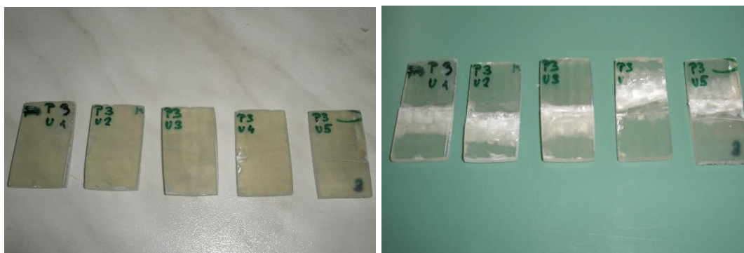
Slika 34. Epruvete prije i poslije ispitivanja međuslojne čvrstoće
