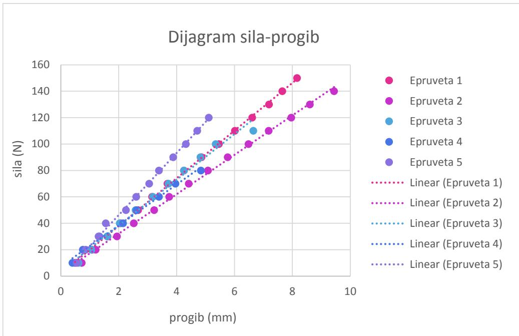
Slika 25. Dijagram ovisnosti produljenja o opterećenju za uzorak 2
