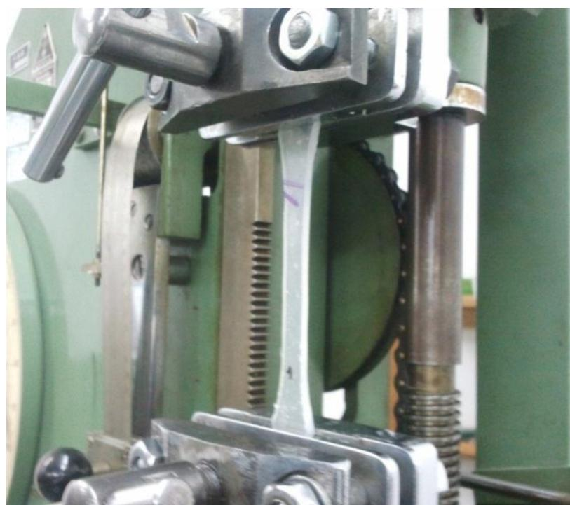
Slika 39. Kidanje epruvete prilikom statičkog rasteznog pokusa
