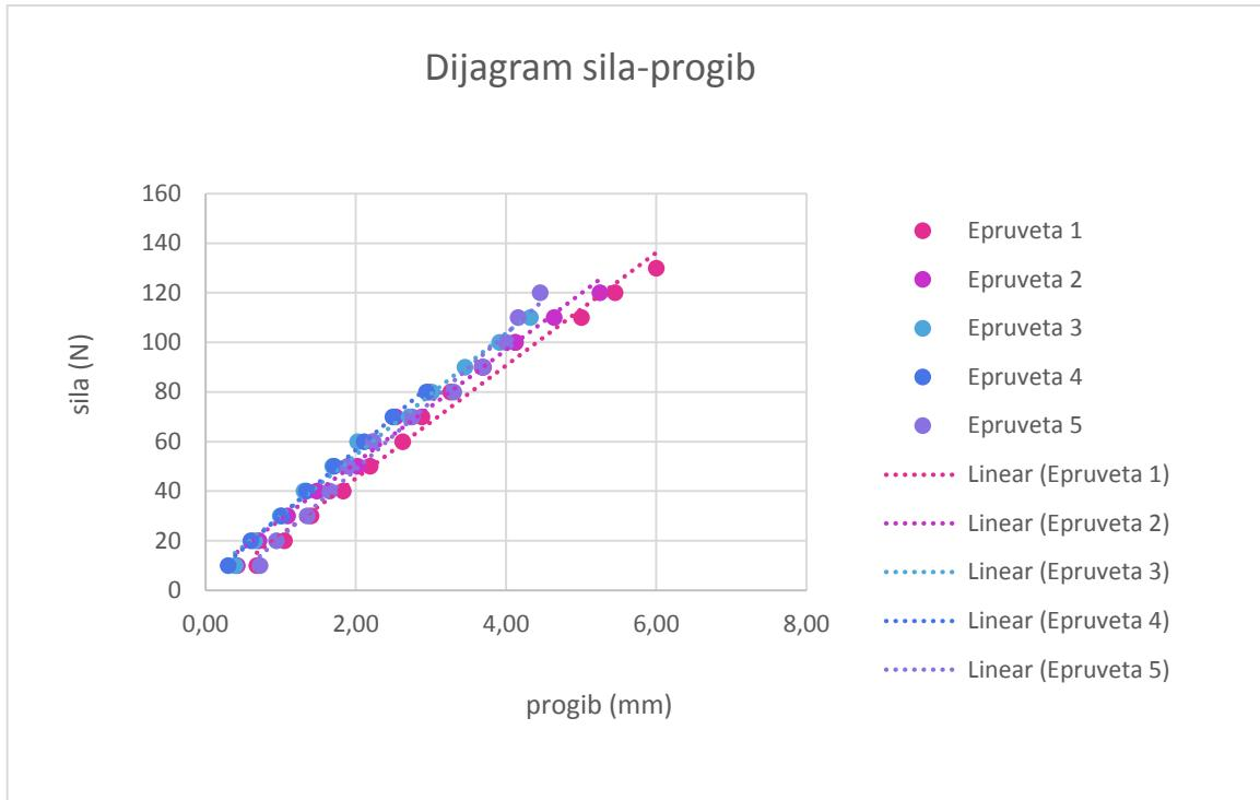
Slika 48. Dijagram ovisnosti produljenja o opterećenju za uzorak 4
