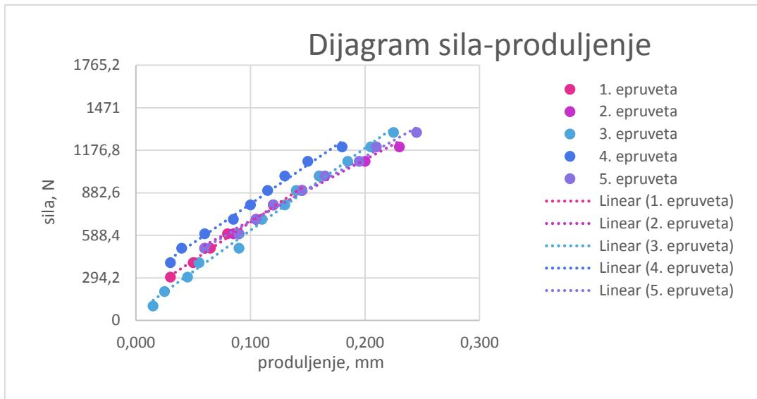
Slika 52. Dijagram ovisnosti produljenja o opterećenju za uzorak 5
