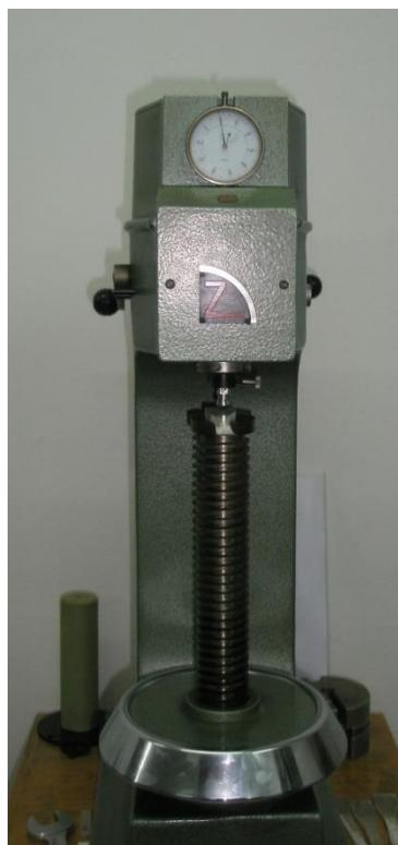
Slika 35. Uređaj za mjerjenje tvrdoće Wwick 3106
