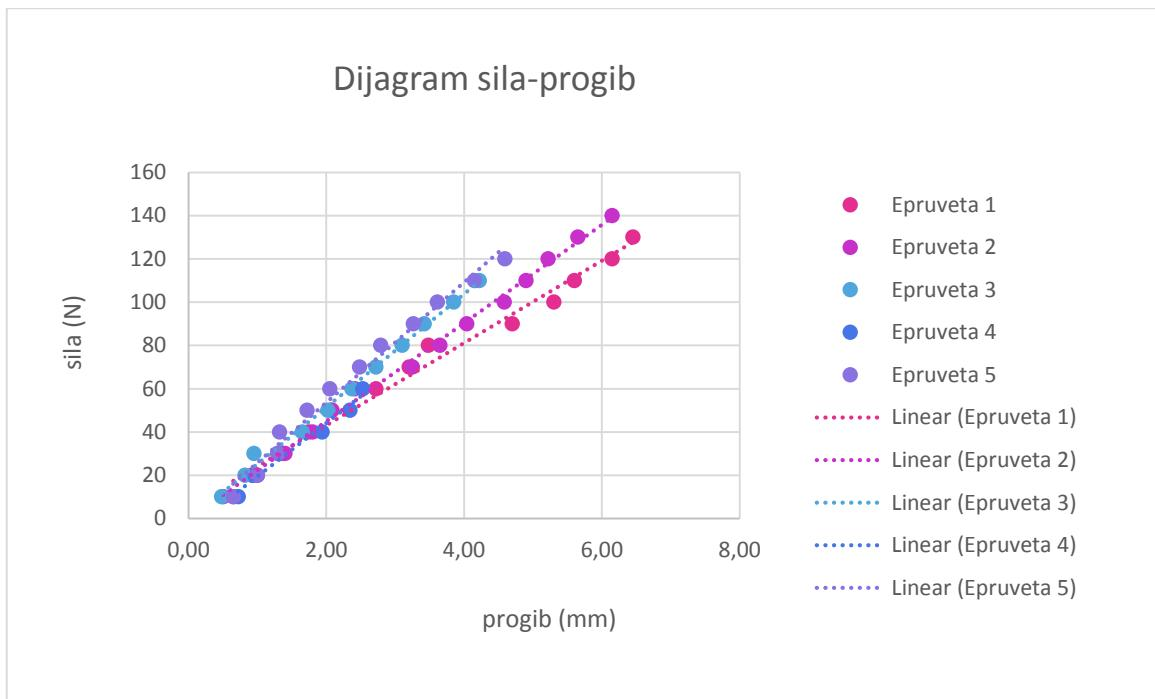
Slika 33. Dijagram ovisnosti produljenja o opterećenju za uzorak 2
