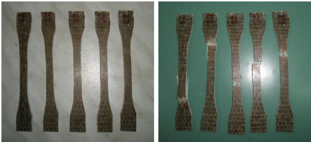
Slika 45. Epruvete prije i poslije ispitivanja rastezne čvrstoće uzorka 4
