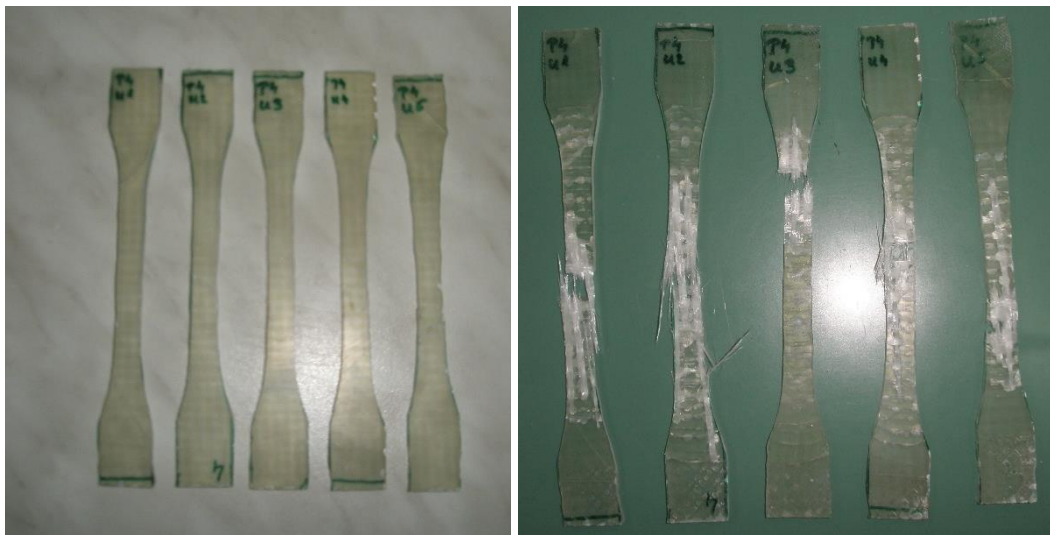
Slika 38. Epruvete prije i poslije ispitivanja rastezne čvrstoće
