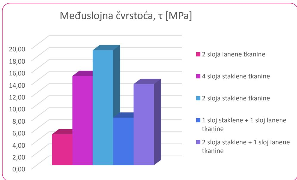
Slika 59. Dijagram usporedbe ispitnih uzoraka prema međuslojnoj čvrstoći
