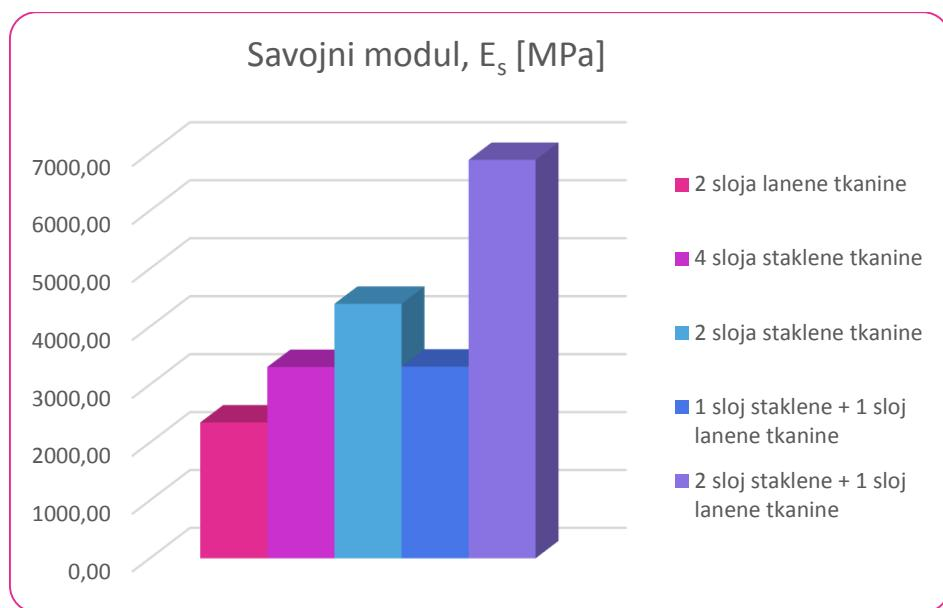
Slika 58. Usporedba uzoraka prema savojnom modulu elastičnosti
