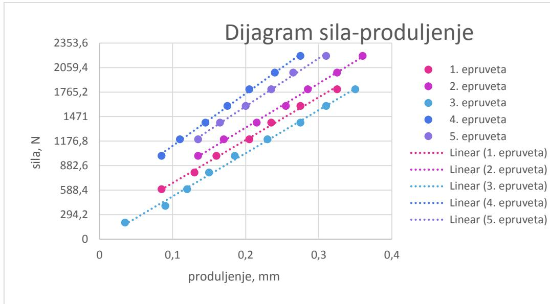
Slika 31. Produljenja pri opterećenjima za uzorak 2
