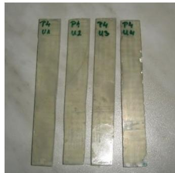
Slika 41. Epruvete za ispitivanje savojne čvrstoće
