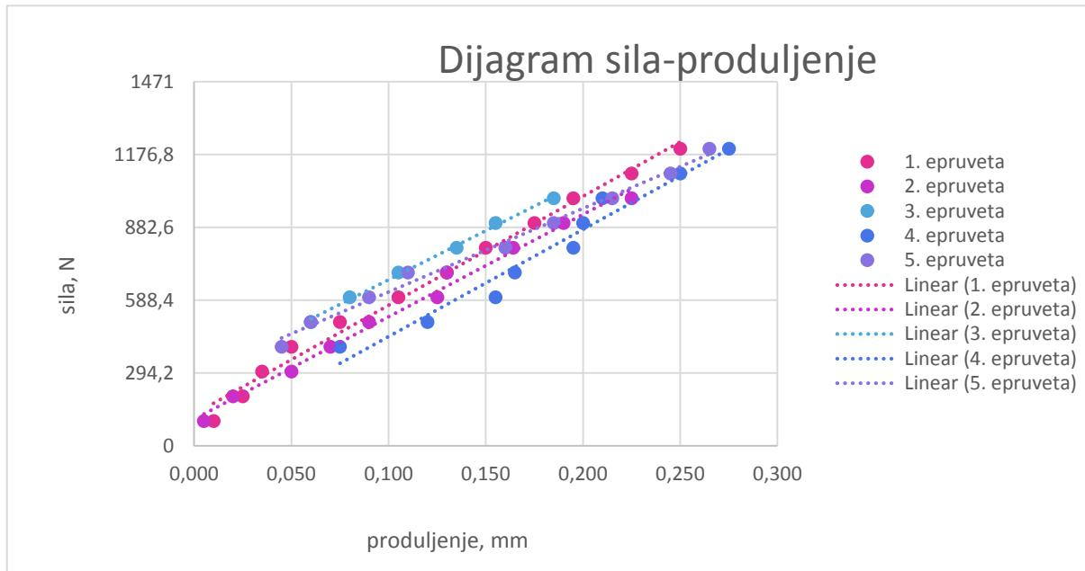
Slika 46. Dijagram ovisnosti produljenja o opterećenju za uzorak 4
