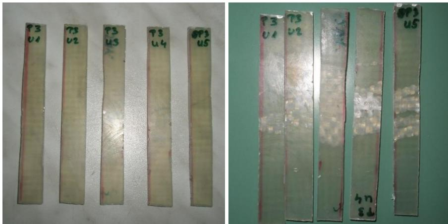
Slika 32. Epruvete prije i poslije ispitivanja savojne čvrstoće
