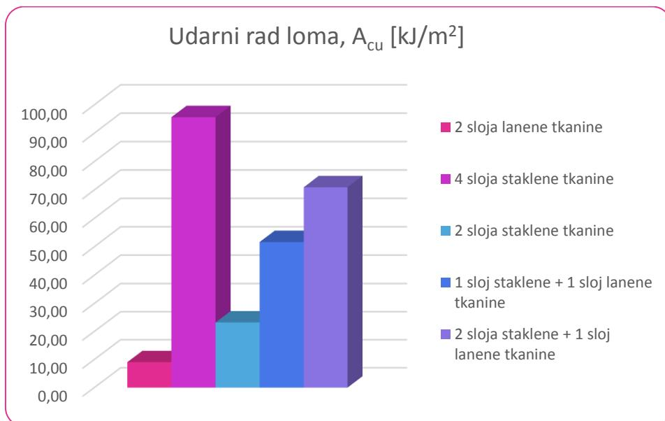
Slika 61. Usporedba uzoraka prema udarnom radu loma
