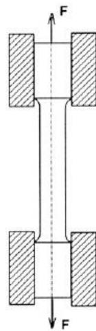
Slika 15. Način opterećivanja epruvete pri statičkom rasteznom ispitivanju [32]
