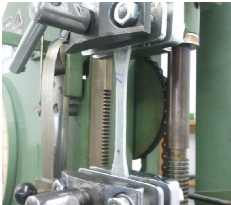
Slika 39. Kidanje epruvete prilikom statičkog rasteznog pokusa
