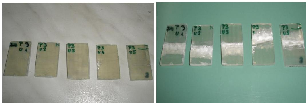
Slika 34. Epruvete prije i poslije ispitivanja međuslojne čvrstoće
