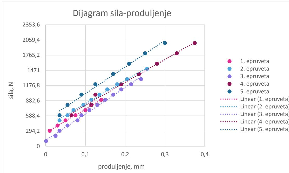
Slika 23. Dijagram ovisnosti produljenja o opterećenju za uzorak 1
