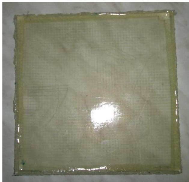
Slika 37. Kompozitna ploča ojačana s dva sloja stakla
