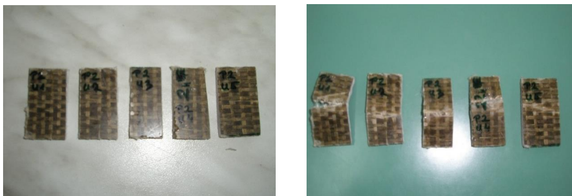
Slika 26. Epruvete prije i poslije ispitivanja međuslojne čvrstoće
