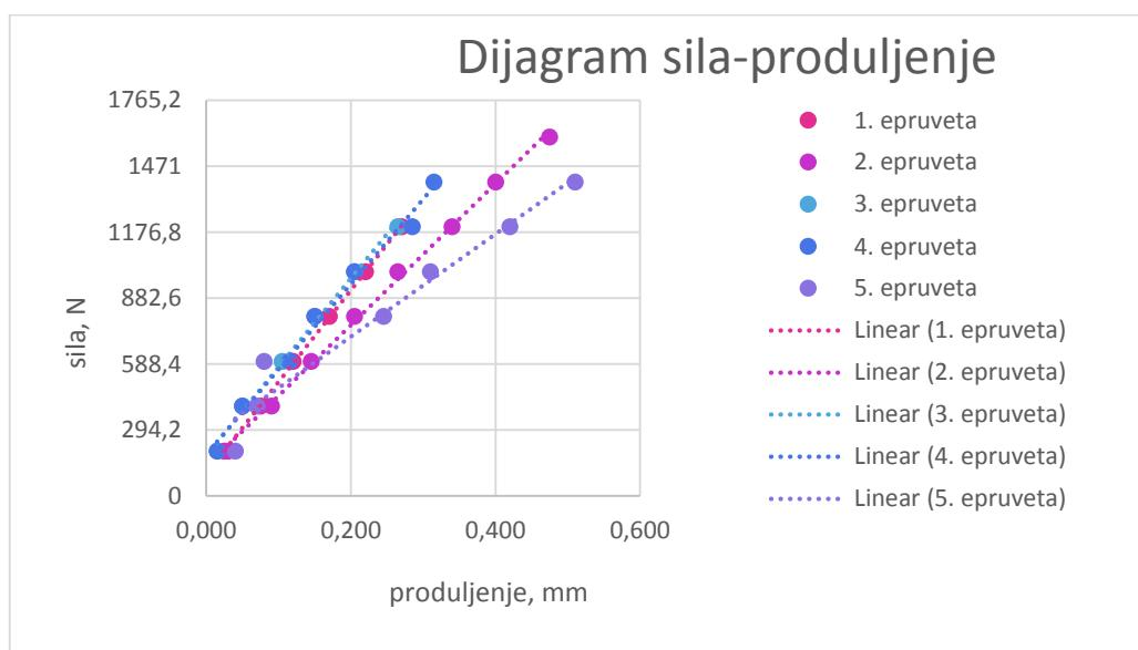
Slika 40. Dijagram ovisnosti produljenja o opterećenju za uzorak 3
