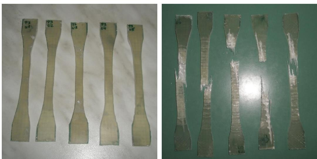
Slika 30. Epruvete prije i poslije rasteznog ispitivanja
