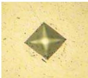
*Slika 7.4.3 Otisak na površini materijala nakon ispitivanja tvrdoće*
