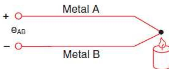
*Slika 5.3.1 Princip djelovanja termopara*
