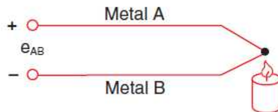
Slika 5.3.1 Princip djelovanja termopara
