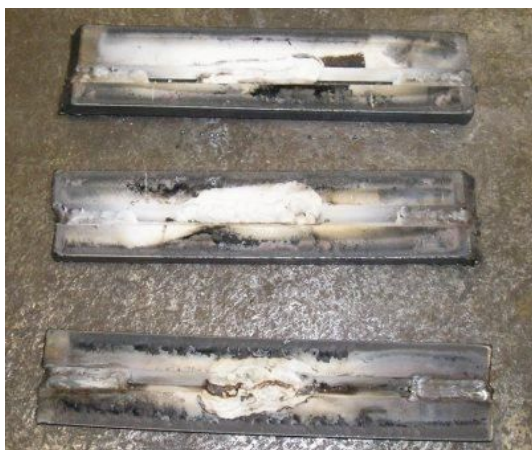
Slike 3.5.15 Uzorci pripremljeni za hladno rezanje uz pomoć pile
