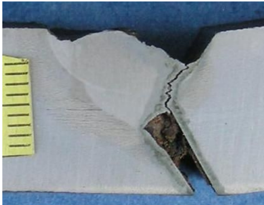
Slika 4.2.8 Makroizbrusak uzorka 22 sa unosom topline 15 kJ/cm
