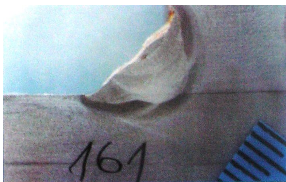
Slika 2.2.3 B-klasa zavara prema AWS D3.6 [43]
