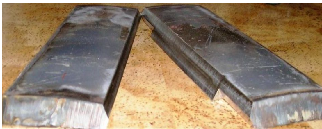
Slika 3.5.3 Nacrt za obradu ploča glodanjem i prikaz pripreme uzorka nakon strojne obrade
