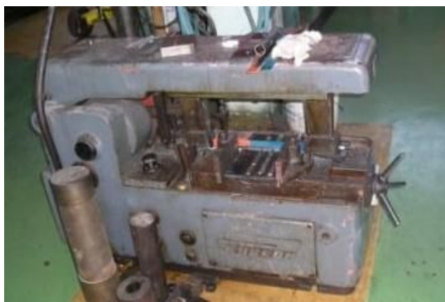
Slike 3.5.15 Uzorci pripremljeni za hladno rezanje uz pomoć pile
