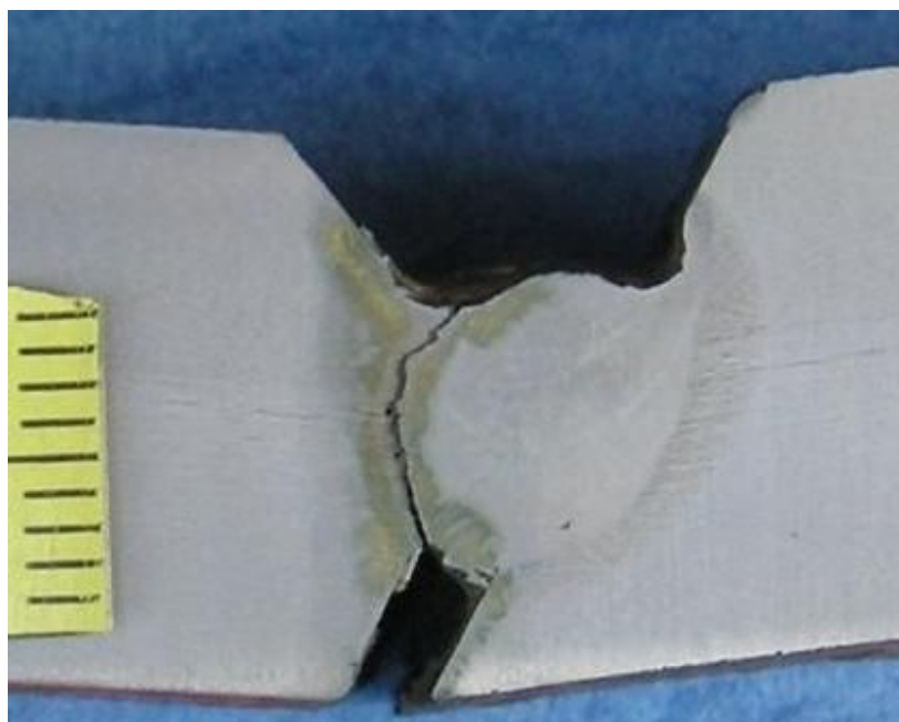
Slika 4.2.2 Makroizbrusak uzorka 11 sa unosom topline 12 kJ/cm
