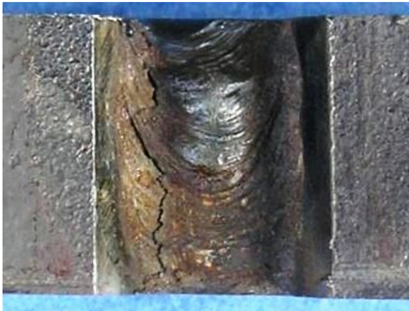
Slika 4.2.1 Lice zavora uzorka 11 sa unosom topline 12 kJ/cm
