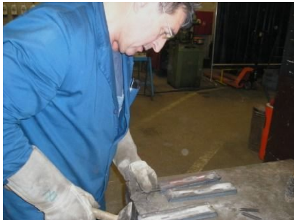
Slika 3.5.14 Numeriranje i zacrtavanje iglom
