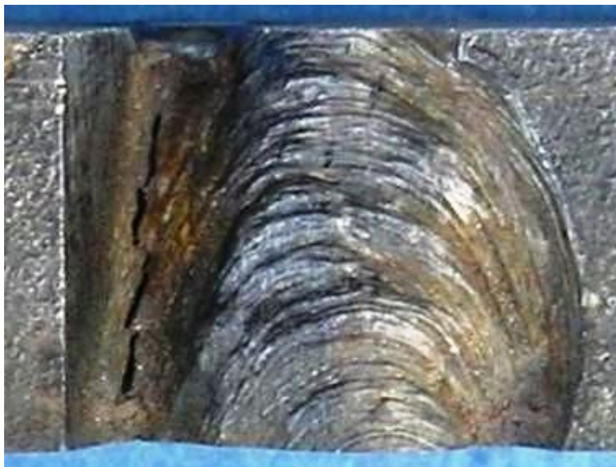
Slika 4.2.5 Lice zavara uzorka 21 sa unosom topline 15 kJ/cm
