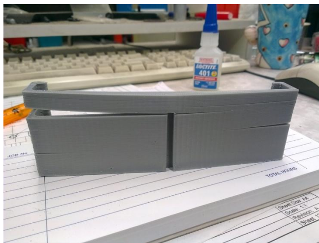
Slika 3.32 Raslojavanje modela zbog preniske temperature [50]
