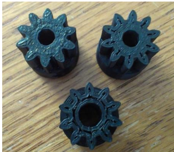
Slika 3.33 Neispunjavanje materijalom do kraja [51]
