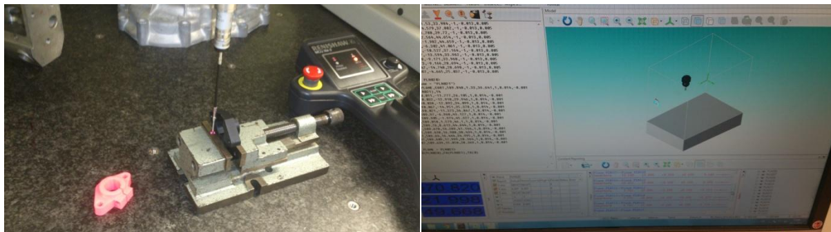
Slika 5.26 Mjerenje debljine držača osovine (SHF 16)
