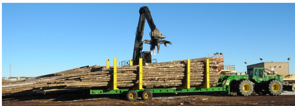
Slika 10. Prikolica za prijevoz drvenih trupaca [5]
