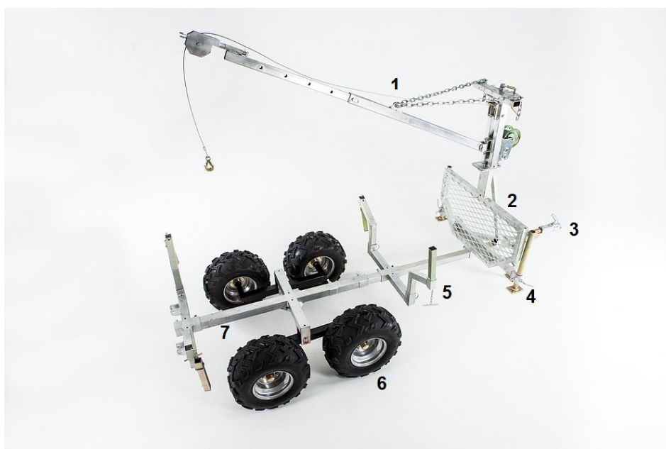
Slika 23. Prikaz glavnih dijelova traktorske prikolice T-Rex [15]
