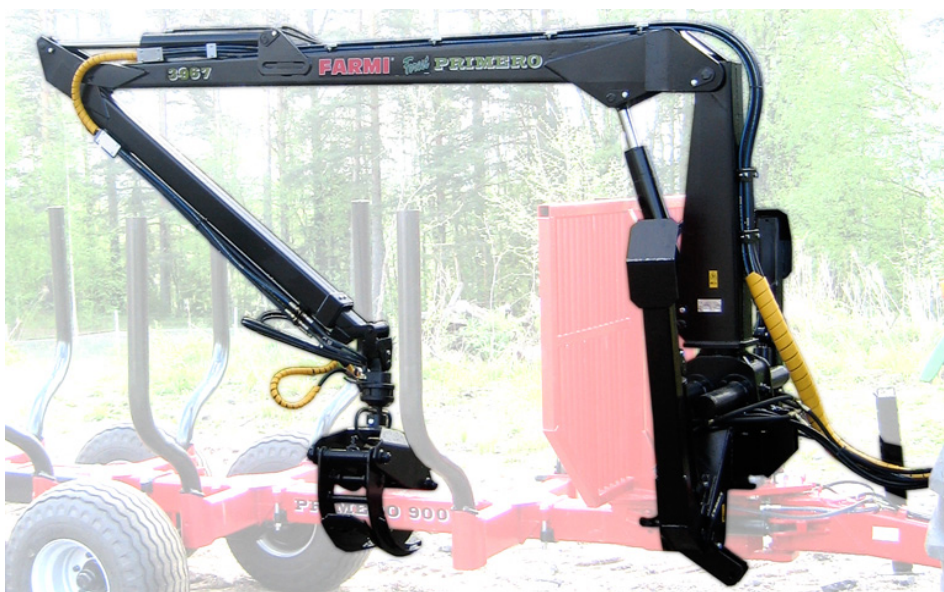
Slika 19. Primjer dizalice za utovar tereta [14]
