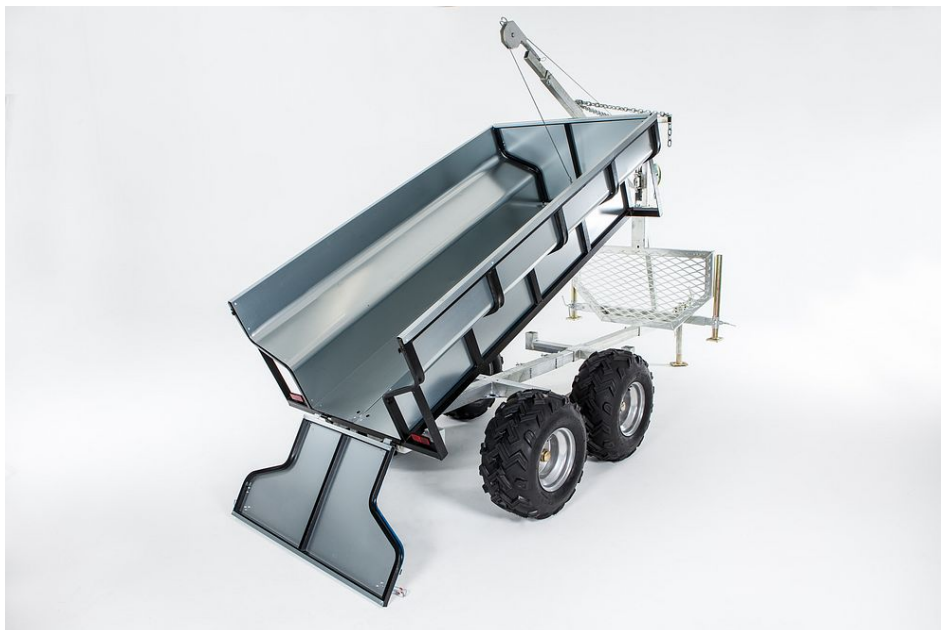
Slika 21. Traktorska prikolica T-Rex s nagnutim teretnim prostorom i otvorenom stražnjom stranicom [15]
