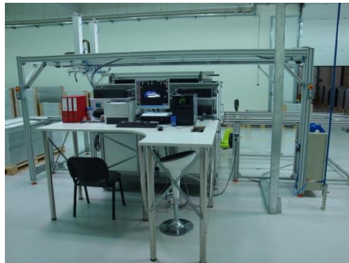
Slika 14. QuickSun 540LA – stroj za testiranje U – I karakteristika [19]
