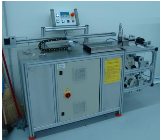
Slika 8. Stroj RC05A – stroj za rezanje spojnih traka [19]
