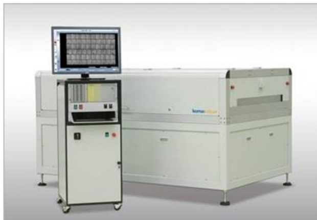
Slika 13. Xinspect 4000S – stroj za elektro-luminiscentno testiranje [21]
