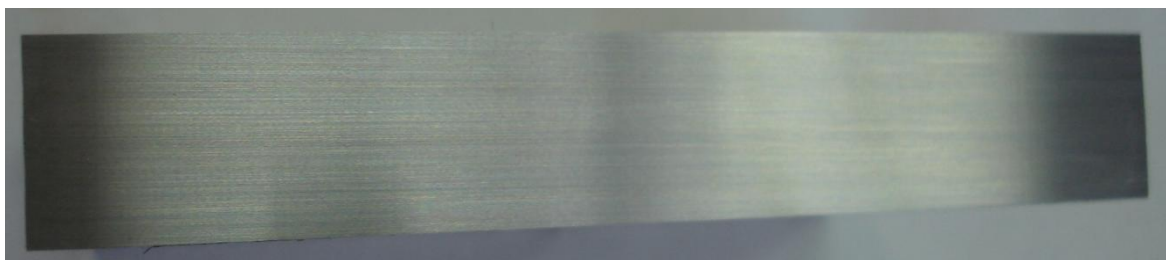
Slika 38. Površina obratka materijala 1.2842 bez pogreška brušenja
