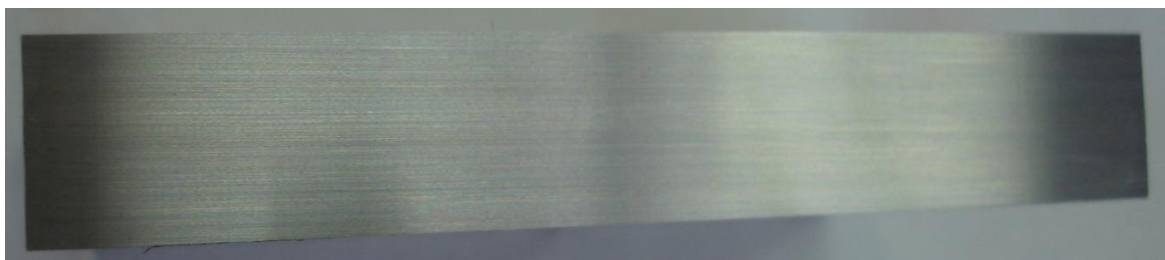
Slika 38. Površina obratka materijala 1.2842 bez pogreška brušenja
