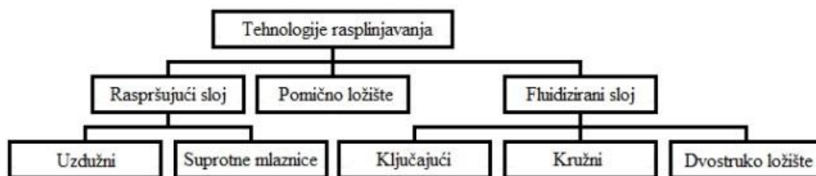
Slika 5. Vrste tehnologija za rasplinjavanje [8]
