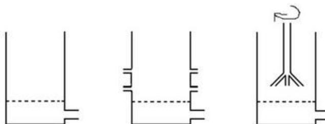
Slika 13. Različite konstrukcije grla kod istosmjernog (oborinskog) reaktora [15]
