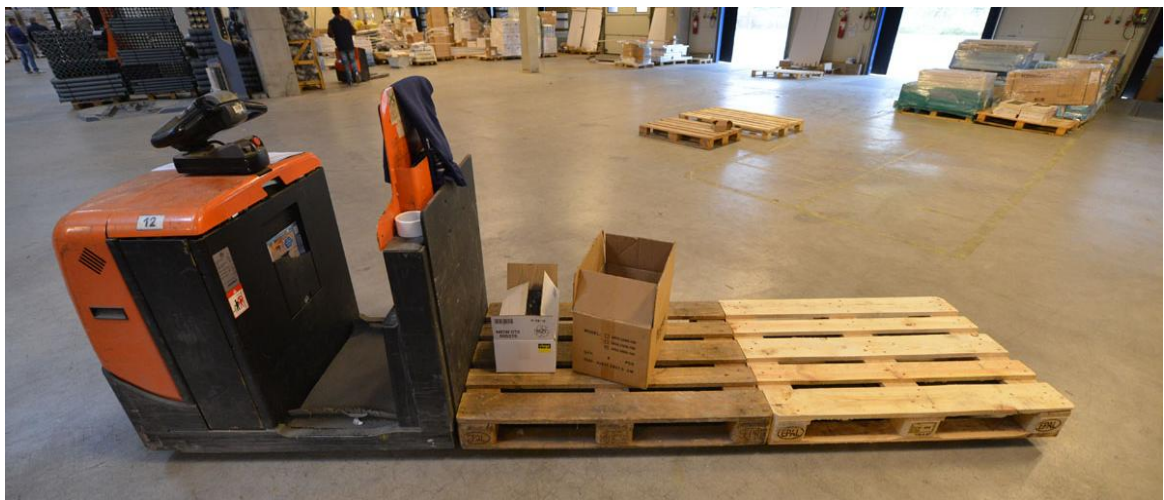
Slika 50. Usporedba električnog viličara za komisioniranje s kratkim i dugačkim vilicama u skladištu poduzeća Feroterm
