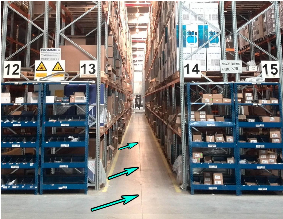
Slika 53. Linija u podu koju prati podni senzor vrlouskoplaznog viličara u skladištu poduzeća Feroterm
