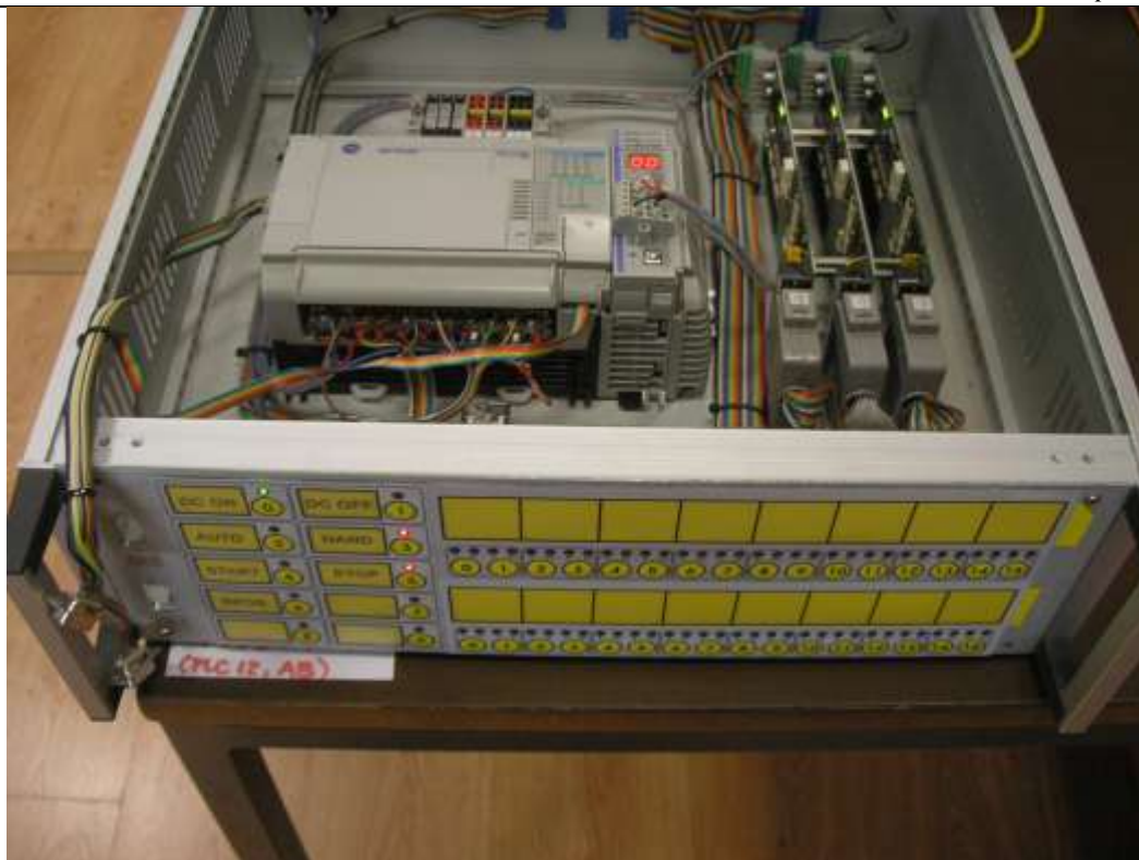
Slika 26. Allen-Bradley Micrologix 1500 PLC ugrađen u kućište od ELK PLC-12
