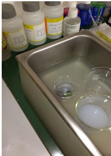
Slika 20. Uzorak u ultrazvučnoj kupelji
