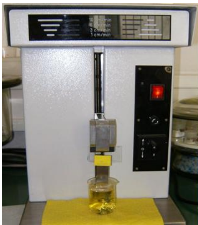
Slika 22. Uređaj za uranjanje i izranjanje uzorka
