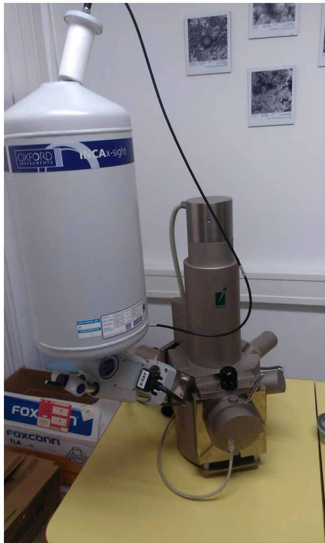
Slika 73. SEM elektronski mikroskop Tescan Vega 5136 MN.
