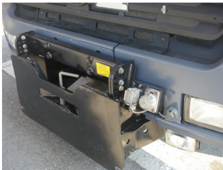
Slika 5. Prednja ploča (prihvat snježnog pluga) [4.]
