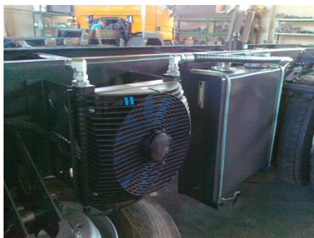
Slika 27. Hladnjak i rezervoar radnog fluida [4]
