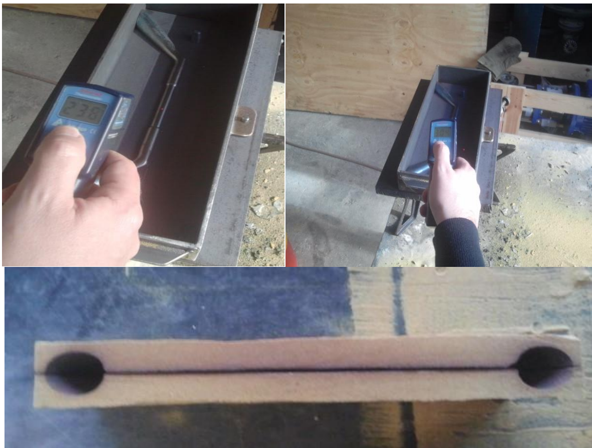
Slika 39. Temperature ploče i epruvete, spojene školjke smjese PFA 90-16
