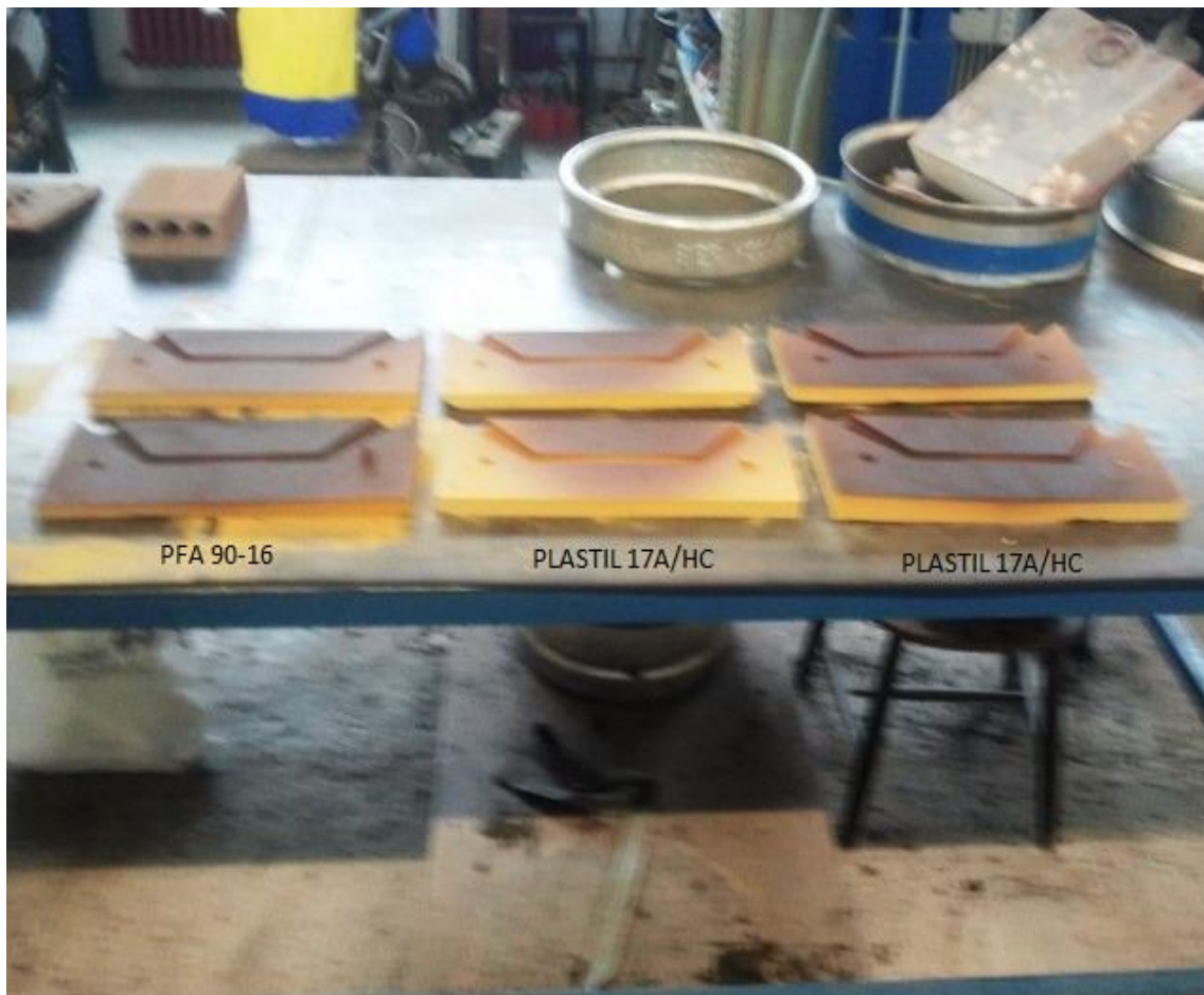
Slika 40. Izrađene školjke spremne za spajanje
