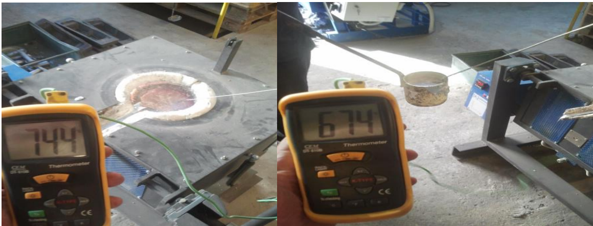
Slika 42. Temperatura taljevine u peći, temperatura taljevine u loncu
