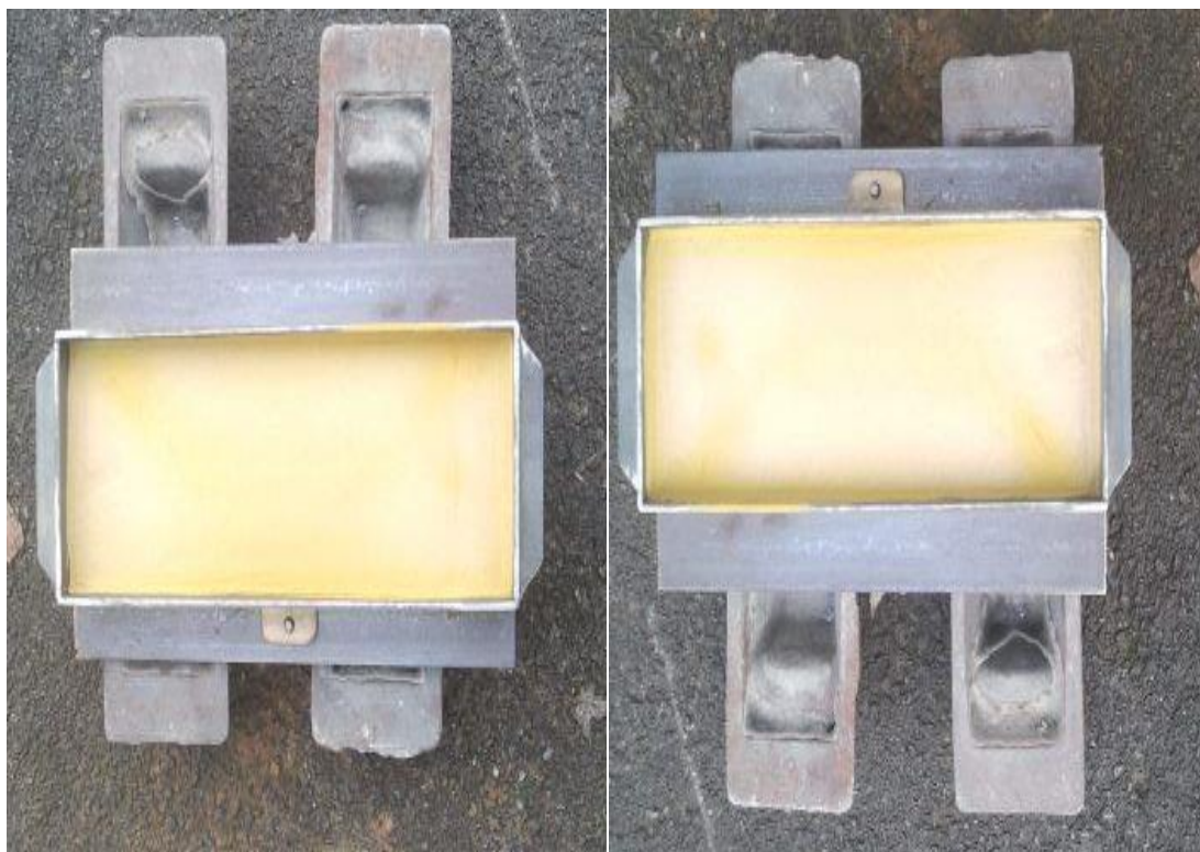
Slika 38. Hlađenje školjke i alata na zraku.
