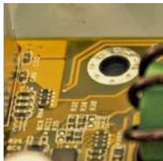
Slika 6.5 Izgled provrta i ojačanog prstena
