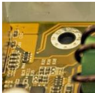
Slika 6.5 Izgled provrta i ojačanog prstena
