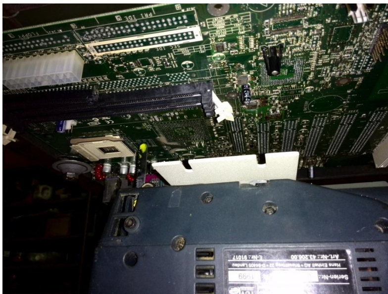
Slika 3.3 Stanje ploče usred procesa, otpalo je mnogo komponenti
