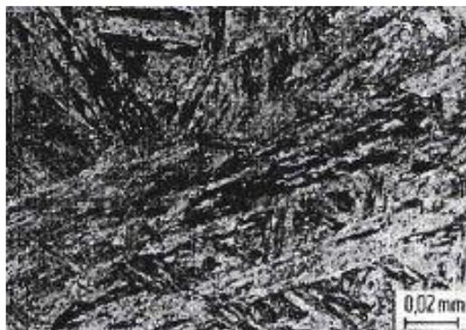
Slika 7. Mikrostruktura martenzitnog nehrđajućeg čelika [2]
