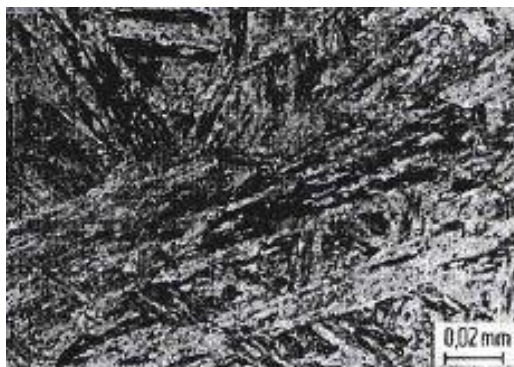
Slika 7. Mikrostruktura martenzitnog nehrđajućeg čelika [2]
