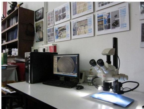
Slika 24. Stereomikroskop model Leica MZ6
