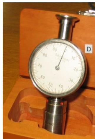
Slika 6.20. Uređaj za mjerenje tvrdoće Shore D
