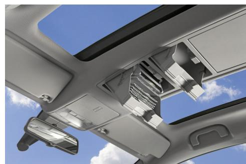
Slika 5.15. Krov automobila izrađen od mješavine ABS/PA [27]
