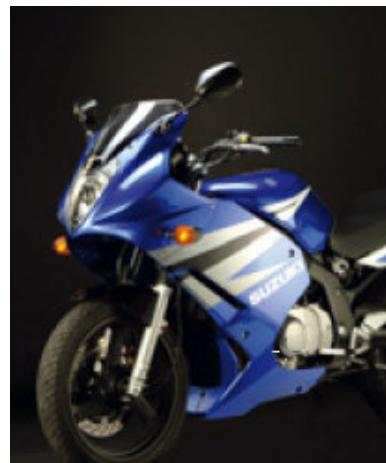
Slika 5.10. Dijelovi karoserije motocikla od ABS-a [13]
